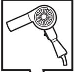
**HEAT PTO COVER AROUND FLANGE TO EXPAND SEALER BEAD. APPLY RTV AROUND OUTER EDGE OF FLANGE.**
