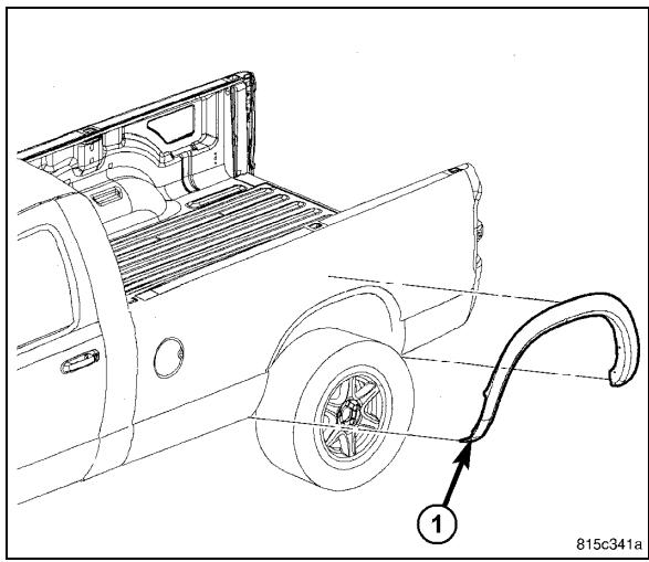
5. Coloque el pasador de presión (1) en primer lugar para corregir la posición del ensanche. Coloque los seis tornillos (2) en orden empezando por el centro y continuando hacia el exterior. Para lograr un ajuste correcto, sujeté el ensanche contra la aleta mientras aprieta los tornillos. Apriete los tornillos a 2,3 N·m (20 lb in).
