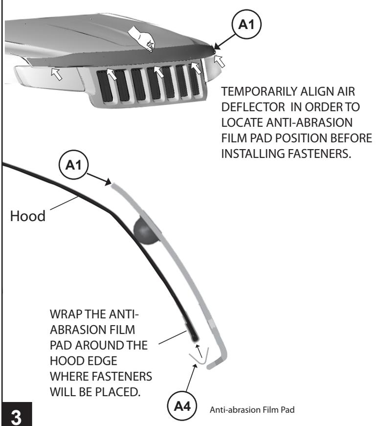
TEMPORARILY ALIGN AIR DEFLECTOR IN ORDER TO LOCATE ANTI-ABRASION FILM PAD POSITION BEFORE INSTALLING FASTENERS.
