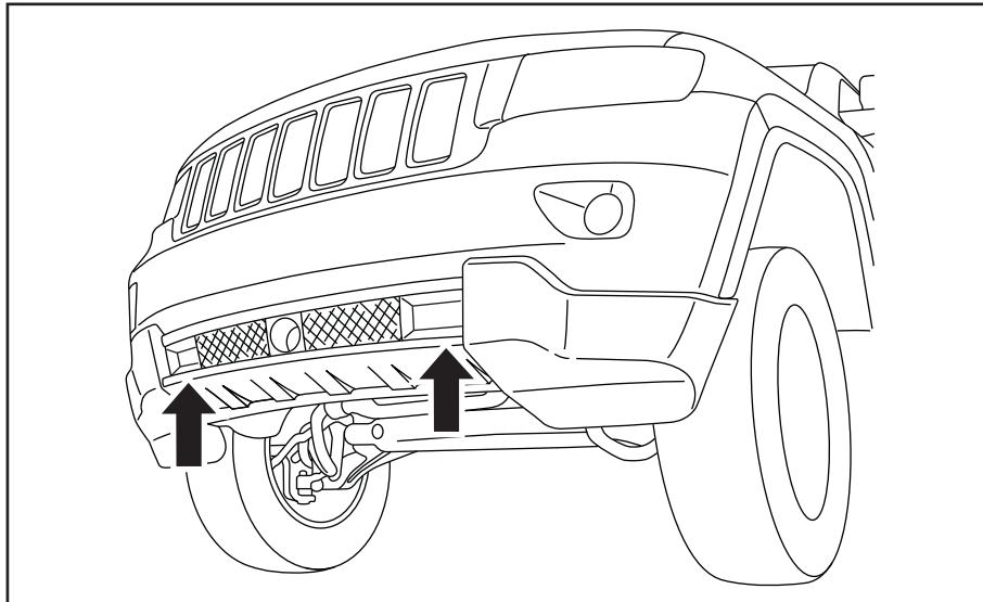
2. Déposez la plaque de couverture avant, les panneaux de garniture intérieur et inférieur du pare-chocs.
