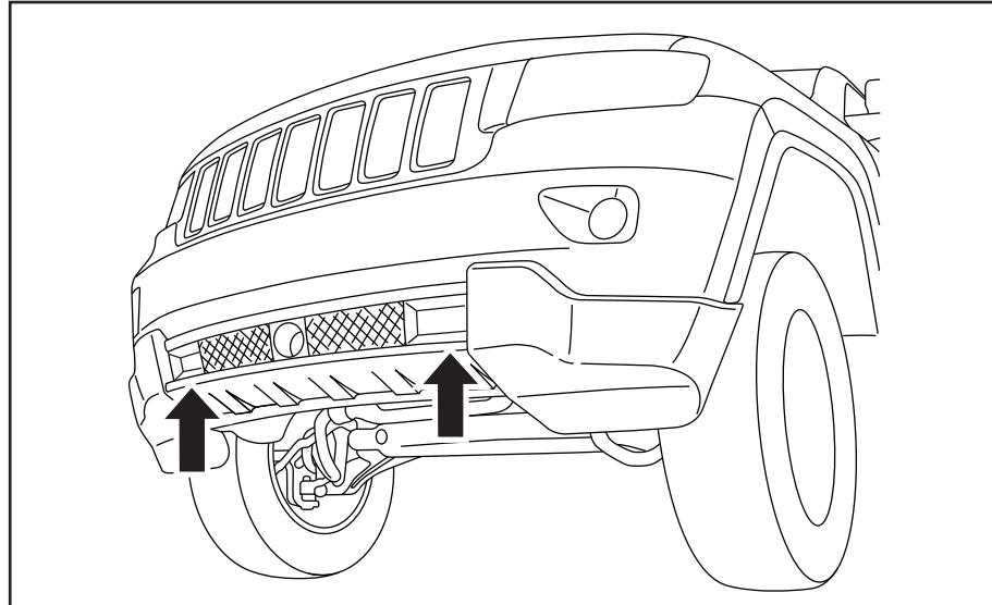
2. Desmonte la placa protectora inferior delantera, el panel de guarnición interior del guardabarros y el panel de guarnición delantero inferior del guardabarros.
