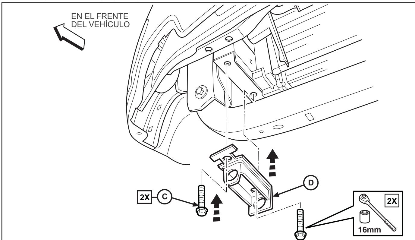
4. Instale el soporte del espaciador, cinta de doble cara, dos (2) espaciadores, la placa protectora y el gancho para remolque como se ilustra utilizando dos (2) pernos de 18mm, dos (2) roldanas, dos (2) tuercas y una (1) tuerca de 30mm que vienen incluidas. Apriete los pernos de 18mm a 47 Nm (35 pies-lb). Apriete el perno de 30mm a 25 Nm (18 pies-lb).
