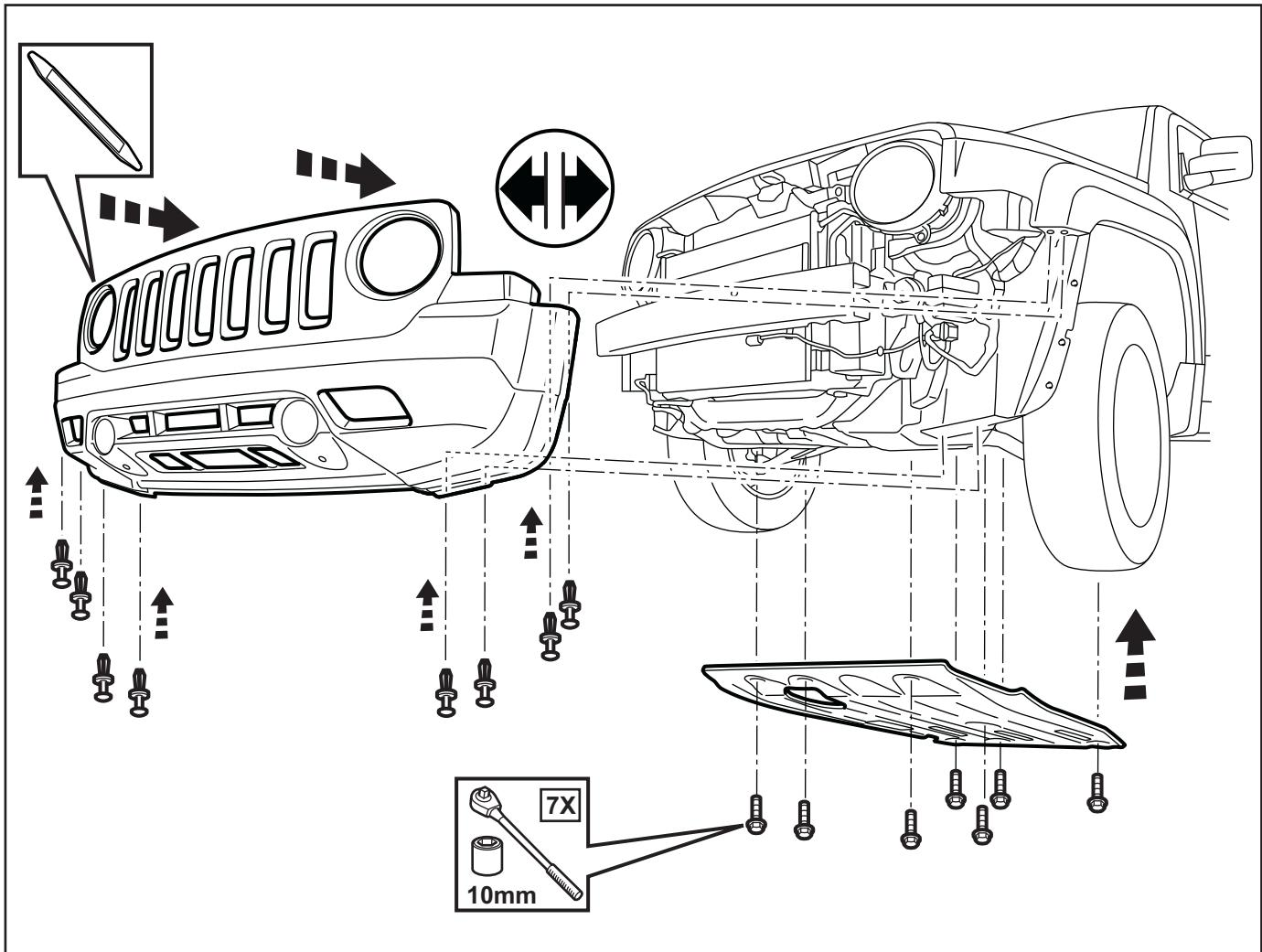
6. Réinstallez les (4) attaches le long du carénage avant.
