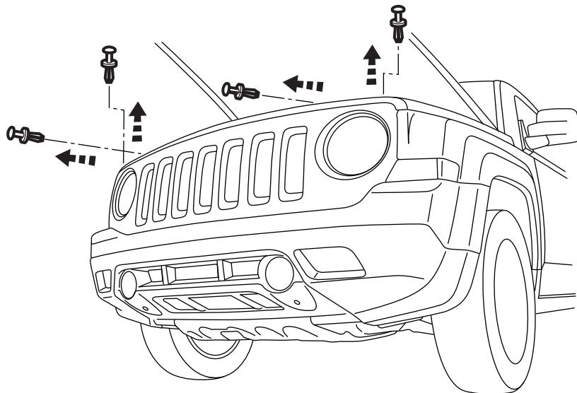
3. Eleve el vehículo sobre una rampa. Desmonte la cubierta protectora inferior delantera. Desconecte los broches del hueco del neumático y quite los sujetadores de retención según se ilustra. Desenchufe los conectores eléctricos y desmonte el panel del tablero.
