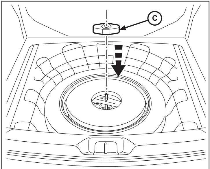
8. Reposez le panneau d'accès à la cavité sous le plancher du coffre.
