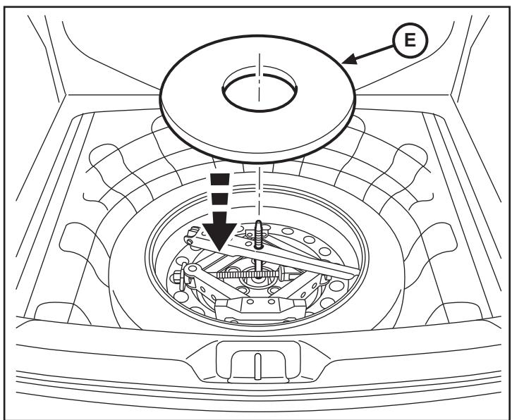
7. Serrez fermement l'assemblage pneu de rechange et cric à l'aide de l'écrou à oreillettes. Ne pas serrer outre mesure.
