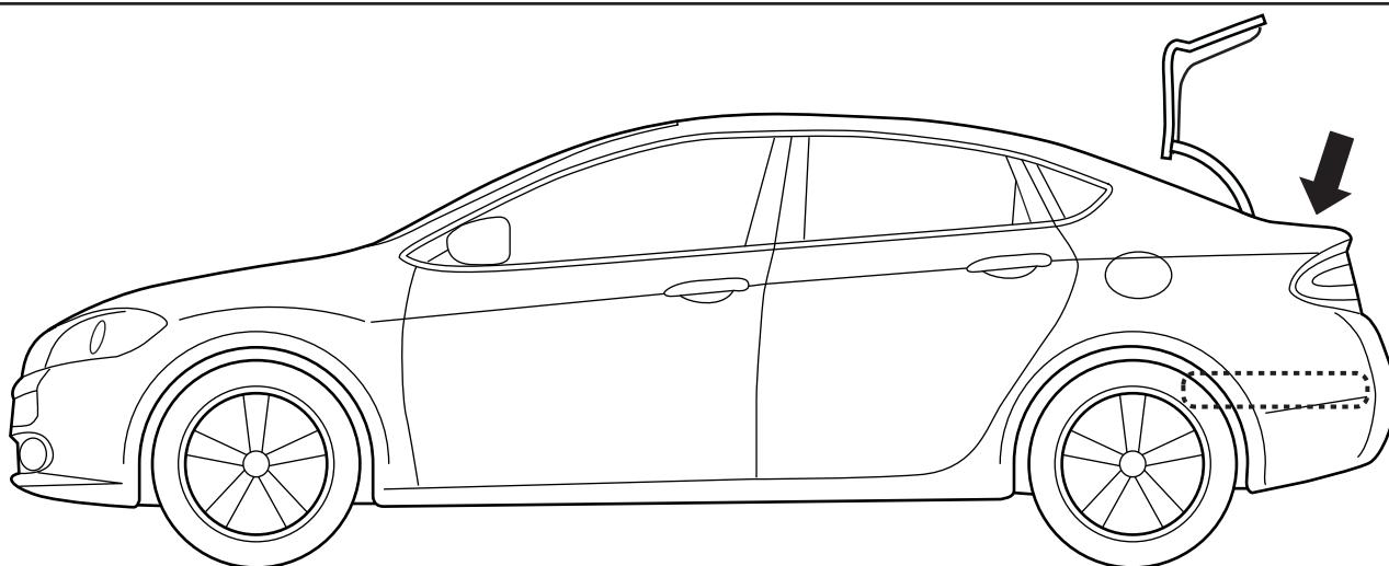
2. Ouvrez le coffre arrière. Déposez le panneau d'accession à la cavité sous le plancher.
