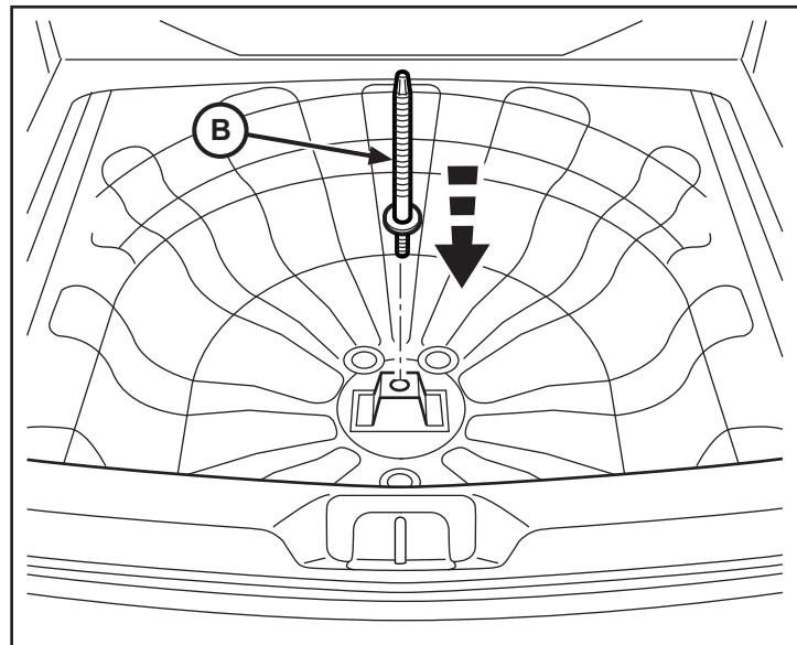
4. Placez le pneu de rechange dans la cavité en vous assurant de faire passer la tige de montage dans le centre de la jante.
