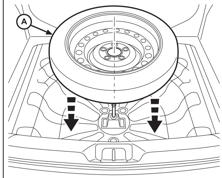
5. Insérez lentement le cric sur la tige de montage et dans la jante du pneu de rechange. Assurez-vous que la tige sort du trou central de la poignée du cric.
