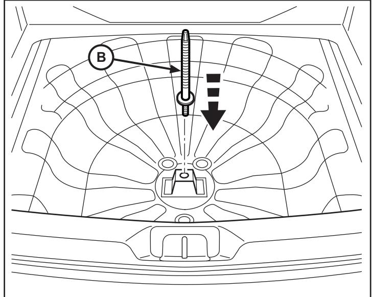
4. Coloque el neumático de repuesto en la cavidad de la cajuela cerciorándose de que el eje pasa a través del centro del neumático.
