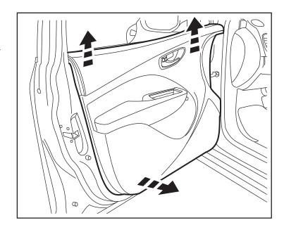
12. Sur la face interne du panneau, appuyez sur la languette de déclenchement de l'ensemble de poignée de porte à l'aide un bâtonnet levier et déposez l'ensemble. Déposez complètement le panneau de porte et mettez de côté.
