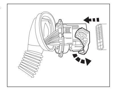
20. À l'arrière du protecteur du faisceau de câbles, déclenchez les cinq (5) languettes pour déposer le couvercle arrière.
