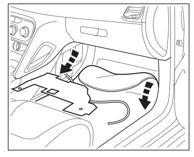
41. Faites cheminer le nouveau faisceau de carrosserie le long du faisceau en place sous le coffre à gants et vers la portière côté passager.
