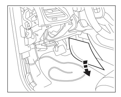
39. Faites cheminer le nouveau faisceau de carrosserie le long du faisceau en place sous le tableau de bord et attachez-les ensemble à l'aide d'attaches comme montré. Assurez-vous que le cheminement du faisceau de câbles derrière l'accélérateur et la pédale de frein ne cause pas d'interférence. Faites passer le faisceau à travers l'empilage central pour le diriger vers le puits de jambe côté passager.
