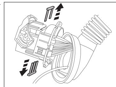
27. Coloque los dos extremos de cable cerca del lado posterior del conector. Introduzca los cables del arnés de la siguiente manera:
