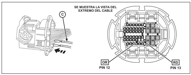
28. El arnés de la carrocería está diseñado para conectarse a ambos lados del vehículo con un arnés en "T" que llegará hasta el BCM. Localice la sección más corta del arnés de la carrocería en relación con el arnés en "T". Coloque los dos extremos de los cables cerca del conector de 48 vías en el interior del espacio para los pies del lado del conductor.
