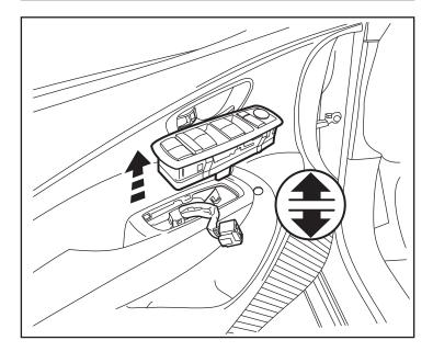
11. Desprenda cuidadosamente la parte inferior del panel de la puerta hacia afuera para desconectar los broches. Levante el panel hacia arriba para liberarlo de la puerta. Desconecte todos los conectores eléctricos de la parte interior del panel de la puerta.
