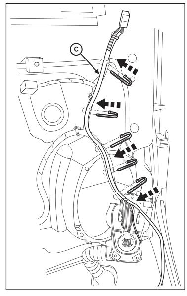
24. Localice el cable negro del arnés en la parte posterior del soporte de la funda. Compruebe que se trata del cable de tierra que se encuentra en la clavija 49 del conector de la puerta/funda. Empalme el cable flexible negro del arnés del espejo con el cable negro situado detrás del soporte de la funda.
