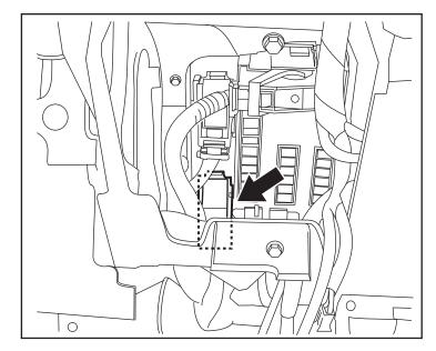
32. Appuyez sur la languette de verrouillage et soulevez le levier de retenue bleu pour dégager le connecteur du faisceau à 60 broches.
