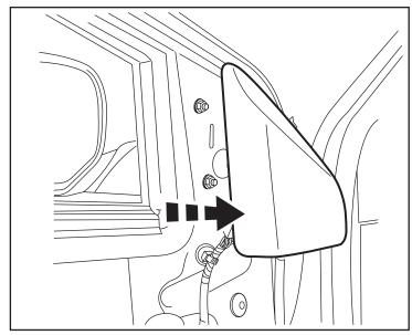
14. Débranchez le connecteur du rétroviseur. Déposez les trois (3) boulons à tête hexagonale de la base de montage interne du rétroviseur et déposez celui-ci.
