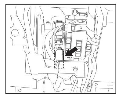
32. Oprima la lengüeta de bloqueo y abata la palanca de retención azul para liberar el conector de 60 vías.
