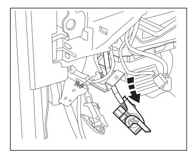
34. Appuyez sur les languettes de dégagement de la coquille du connecteur à 60 broches (à l'arrière du connecteur) et séparez le connecteur de la coquille.
