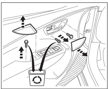
À l'aide de l'outil pour garniture soulevez et retirez le module de commutateur de l'appuie-bras. Débranchez les deux (2) connecteurs rattachés.
