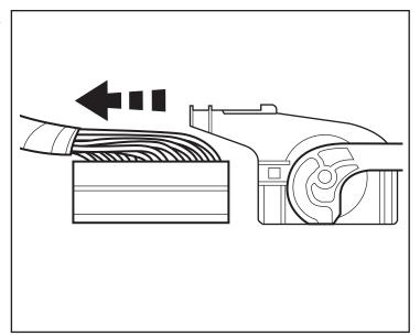
35. Coloque los tres extremos de cable de la sección más corta del arnés de la carrocería cerca del lado posterior del conector. Introduzca los cables del arnés de la manera siguiente:
