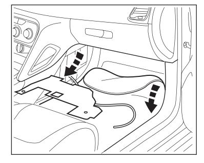
41. Encauce el nuevo arnés de la carrocería junto al arnés existente por abajo de la guantera y hacia la puerta del ocupante. Sujételo con sujeta cables.
