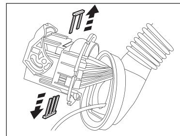
27. Positionnez les deux extrémités de fils à l'arrière du connecteur. Insérez les fils du faisceau dans les socles de broches suivants :
