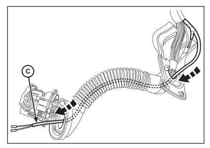
26. À l'aide d'un outil levier, déposez les verrous de raccordement au haut et au bas du connecteur du montant avant.
