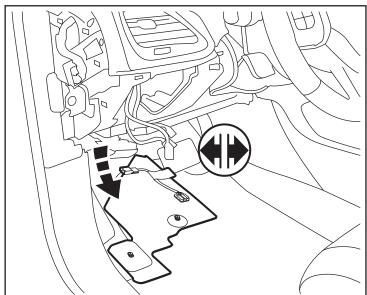
7. Utilice una barra para vestidura para desprender el panel de vestidura del estribo de la puerta.
