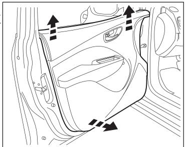
12. Desde la parte interior del panel, use una barra de vestidura para oprimir la lengüeta en el lado posterior del conjunto de la manija de la puerta. Quite el conjunto de la manija. Retire completamente el panel de la puerta y colóquelo a un lado.
