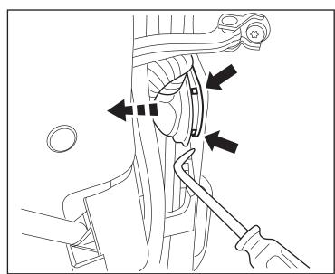
Empuje la lengüeta de bloqueo y abata la palanca de retención para liberar el conector. Extraiga el conector y la funda de cables del borde frontal de la puerta.
