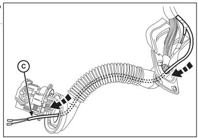
26. Utilice una herramienta para hacer palanca para quitar los bloqueos de la terminal de la parte superior e inferior del conector del poste "A".
