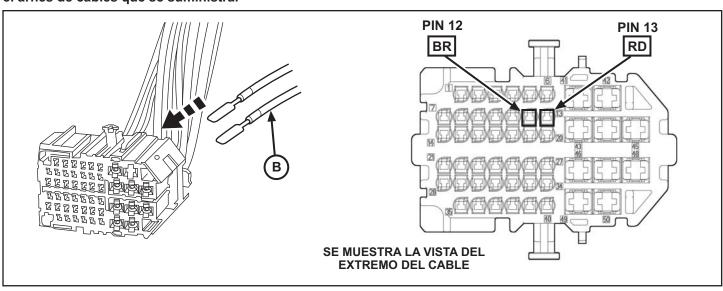
31. Viendo desde arriba el interior del tablero, localice el conector C4 de 60 vías en la esquina inferior izquierda del BCM.
