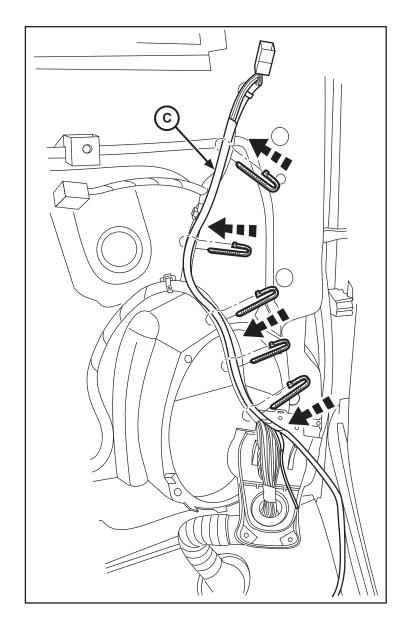
24. À l'arrière du support du protecteur de câbles, localisez le fil noir du faisceau. Confirmez que celui-ci est le fil de masse de la broche 49 du connecteur de portière. Faites une épissure du fil noir en tire-bouchon du nouveau faisceau de câbles de rétroviseur avec le fil noir derrière le connecteur de portière.
