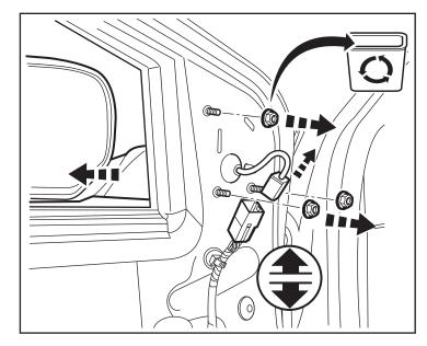
15. Quite dos (2) sujetadores del soporte de la funda de cables ubicada en la parte inferior del borde frontal inferior de la puerta.
