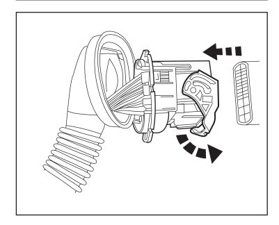
20. Viendo hacia el lado posterior del soporte de la funda de cables, libere las cinco (5) lengüetas para quitar la cubierta trasera.
