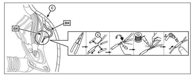
25. Introduzca el extremo del nuevo arnés del espejo a través del tubo de la funda para que salga hacia el conector del poste "A", como se muestra.
