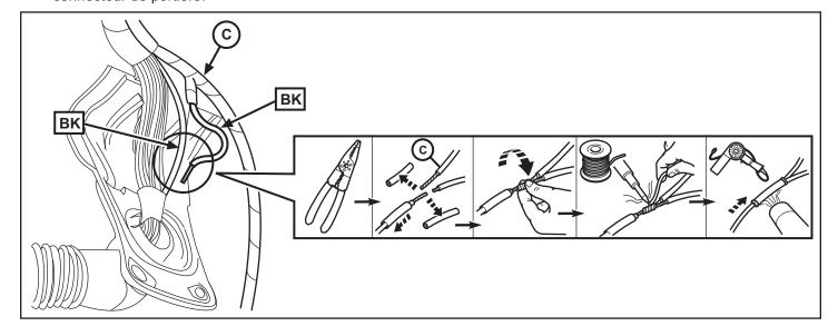
25. Faites passer l'extrémité du nouveau faisceau de câbles de rétroviseur à travers du tube protecteur vers le connecteur du montant avant comme montré.
