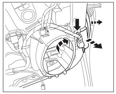
18. Tirez délicatement le couvercle protecteur des câbles près de la penture sur le montant avant de portière. À l'aide d'un outil replié à 90°, enfoncez les quatre (4) languettes pour dégager le bloc de raccordement à 48 broches.
