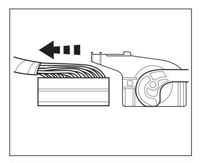
35. Positionnez les trois extrémités des fils de la partie la plus courte du faisceau de carrosserie sur l'arrière du connecteur. Insérez les fils du faisceau dans les socles de broches suivants:
