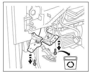
9. À l'aide d'un outil pour garnitures, déposez les garnitures de caoutchouc de l'intérieur de la porte et de l'appuie-bras. Déposez un (1) boulon de 7 mm de l'appuie-bras. Déposez un (1) boulon de 10 mm et une (1) vis Phillips de la poignée de porte.
