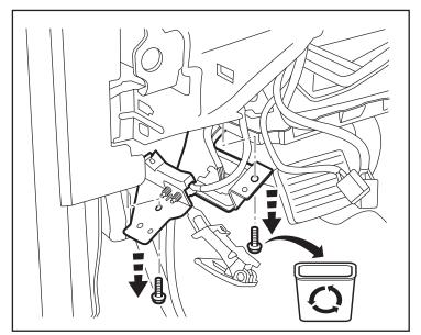
9. Utilice una barra de vestidura para retirar los paneles de vestidura de goma de la parte interior de la manija de la puerta y el descansabrazo. Quite un (1) perno de 7mm del descansabrazo. Quite un (1) perno de 10mm y un (1) tornillo Phillips de la manija de la puerta.
