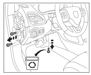
5. Tirez délicatement la garniture vers le bas. Débranchez les quatre (4) connecteurs à l'arrière du panneau. Repoussez la languette de maintien pour dégager l'ensemble de verrouillage du panneau et déposez le panneau.
