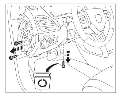
Jale con cuidado hacia abajo el panel. Desconecte cuatro (4) enchufes del lado trasero del panel.
