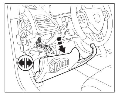
6. À l'aide de l'outil levier, déposez délicatement le panneau sous le tableau de bord. Débranchez le connecteur rattaché.
