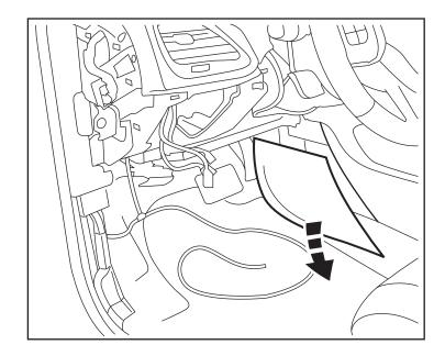
39. Encauce el nuevo arnés de la carrocería junto con el arnés existente debajo del tablero y sujételo con sujeta cables. Asegúrese de que el arnés pasa por atrás de los pedales del freno y del acelerador sin ocasionar ninguna interferencia. Introduzca el extremo del arnés a través del paquete central para que salga por el espacio para los pies del lado del ocupante.
