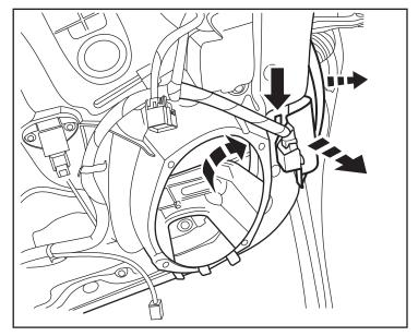
18. Levante con cuidado el sello soldado en el borde frontal de la puerta. A través del hueco de la bocina, presione el broche de montaje para liberar el soporte de la funda de cables desde la parte delantera de la puerta.
