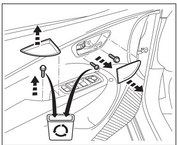
Use una barra de vestidura para desprender el modulo del interruptor del descansabrazo. Desconecte dos (2) enchufes.
