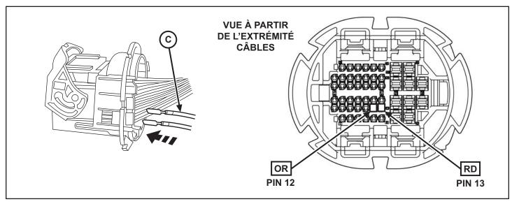
28. Le faisceau de câbles de carrosserie est conçu pour se raccorder au faisceau en « T » qui rejoindra la BCM. Localisez la longueur la plus courte du faisceau de carrosserie en relation au faisceau en « T ». Positionnez les deux extrémités de fils près du connecteur à 48 broches dans le puits pour jambes du conducteur.
