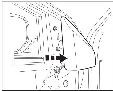
14. Desconecte el enchufe del espejo. Quite tres (3) pernos de 8mm desde los montajes interiores del espejo. Quite el conjunto del espejo.
