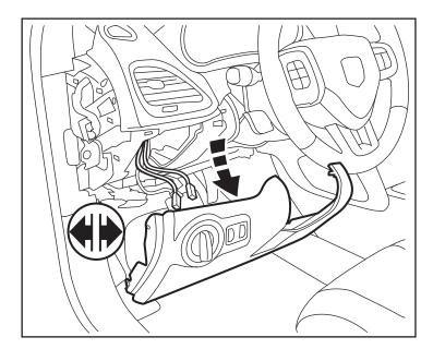
6. Use una herramienta para hacer palanca para retirar con cuidado el panel ubicado debajo del tablero. Desconecte un (1) enchufe.
