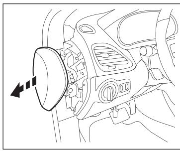
4. Déposez les trois (3) boulons de 7mm de la garniture sous le volant.
