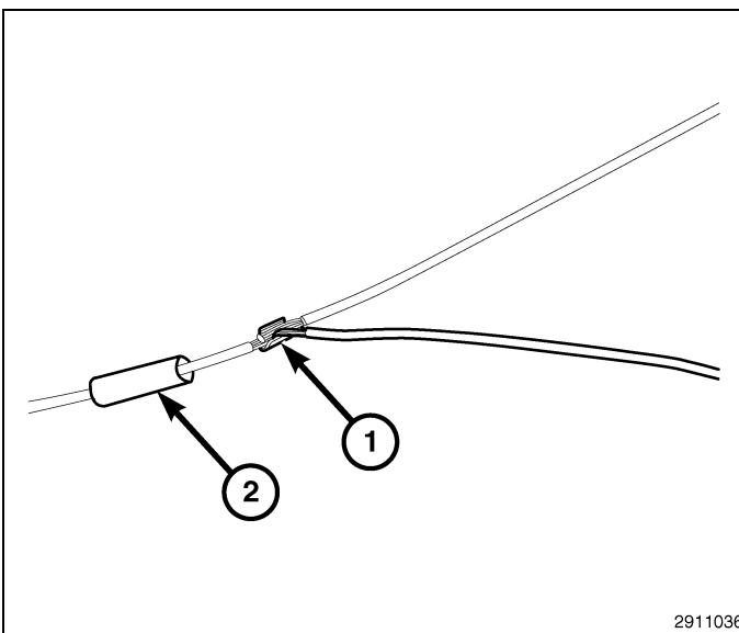
30. Con una crimpadora (1), empalme el clip y los cables.
