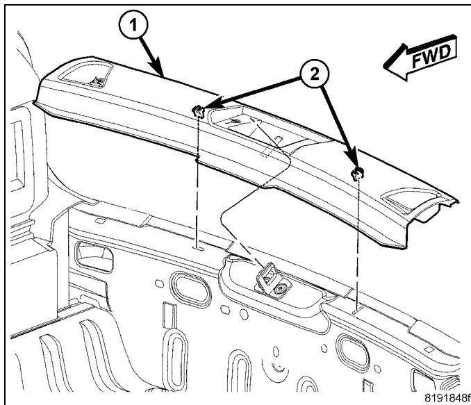
61. Positionner le plancher de chargement dans le véhicule et engager les pivots arrière.
