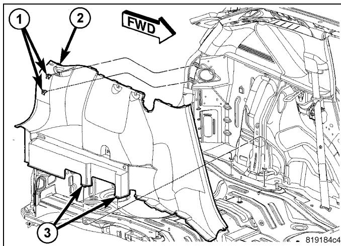
60. Positionner la plaque de protection de seuil de hayon (1) sur le seuil de hayon et l'assujettir avec des brides de retenue (2) complètement.
