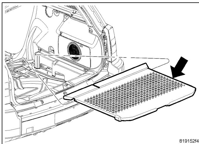
7. À l'aide d'une baguette de garnissage C-4755 dégager les brides de fixation (2) et déposer la plaque de protection de seuil de hayon (1).
