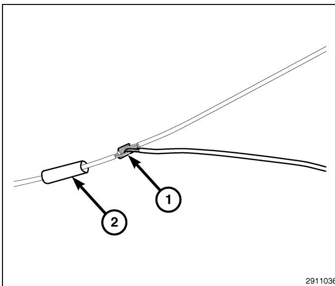
30. À l'aide d'un outil de sertissage (1), sertir l'agrafe d'épissage sur les fils.
