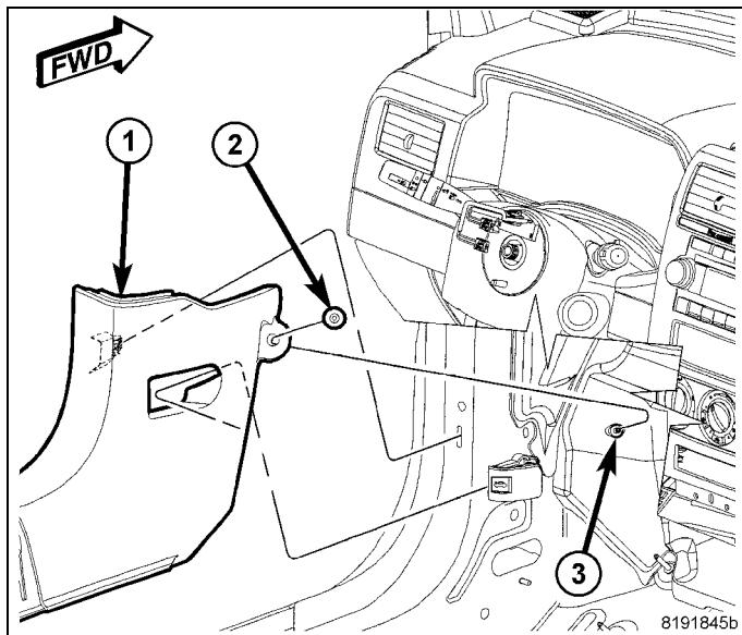
5. Positionner le garnissage du pied milieu inférieur (2) à l'écart.
