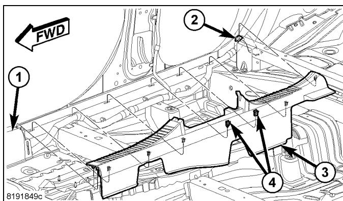
3. Déposer la fixation (2) et dégager la bride de fixation.
