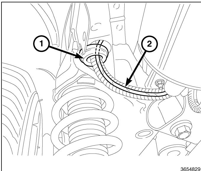
44. À l'aide du tube en plastique spiralé inclus dans la trousse (1), couvrir le faisceau de l'applique et le glisser vers le haut jusqu'à ce que tout le faisceau de l'applique soit couvert.
