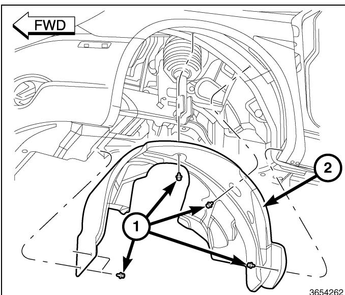
15. Déposer l'oeillet (1) de l'orifice dans la carrosserie au coin de l'aile intérieure avant du côté du conducteur.
