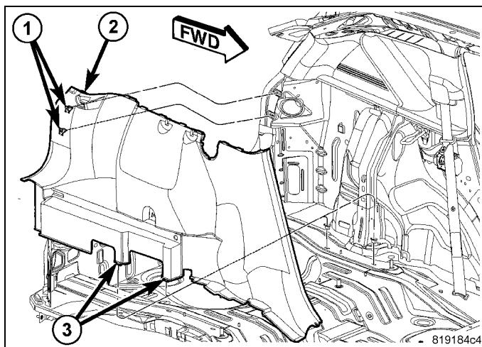
10. Acheminer le faisceau de l'applique (1) le long du faisceau de câblage existant derrière le panneau d'auvent du côté du conducteur.
