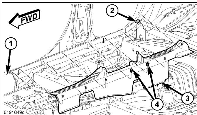
3. Retire el dispositivo de retención (2) y suelte el collarín de retención.
