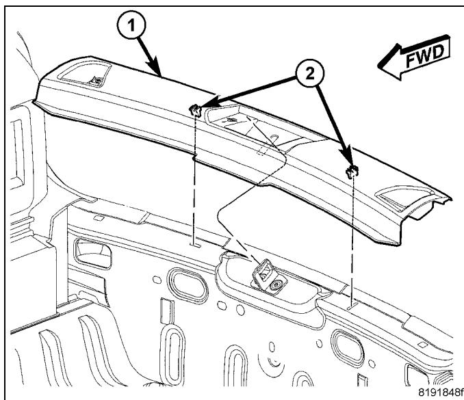
61. Coloque el suelo de carga en el vehículo y acople los pivotes traseros.
