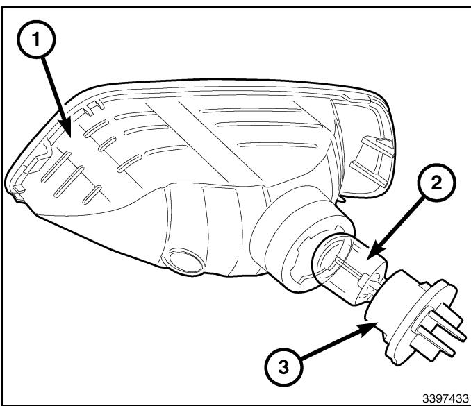
52. Alinee y coloque la lámpara antiniebla (1) en la apertura. Empuje el faro antiniebla para enganchar las lengüetas de fijación.
