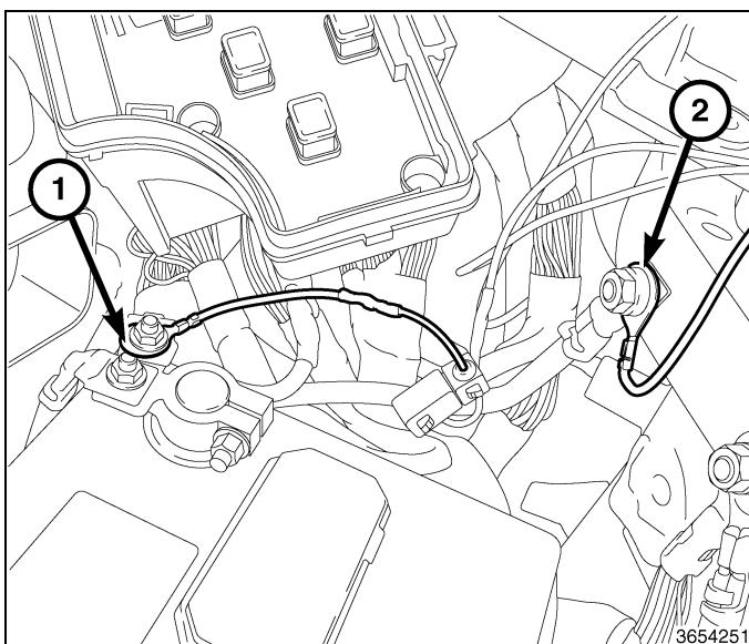
24. Positionner le TIPM de façon à ce que les connecteurs sur la face intérieure soient accessibles.
