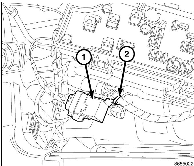
36. Poser à nouveau le TIPM au support. S'assurer que les quatre pattes de fixation sont correctement enfoncées.
