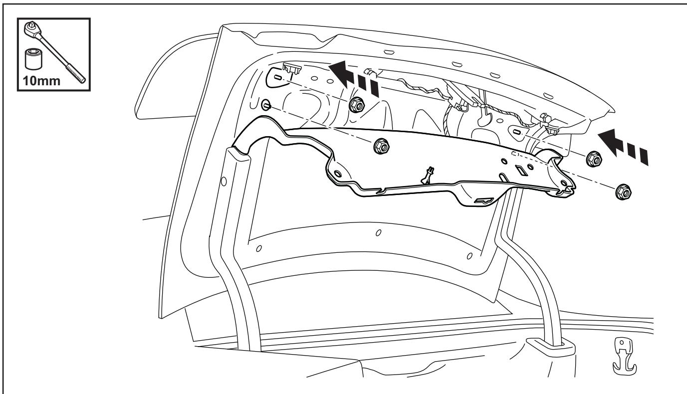
8. Reinstale con cuidado el revestimiento y vuelva a colocar los sujetadores y los broches.
