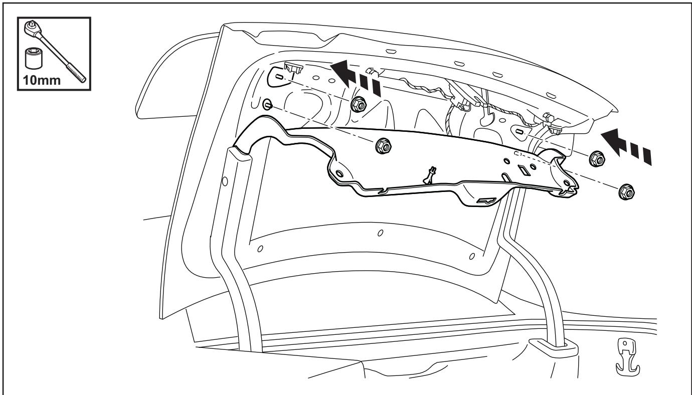
8. Replacez soigneusement le revêtement et remettez en place les attaches et les fixations.
