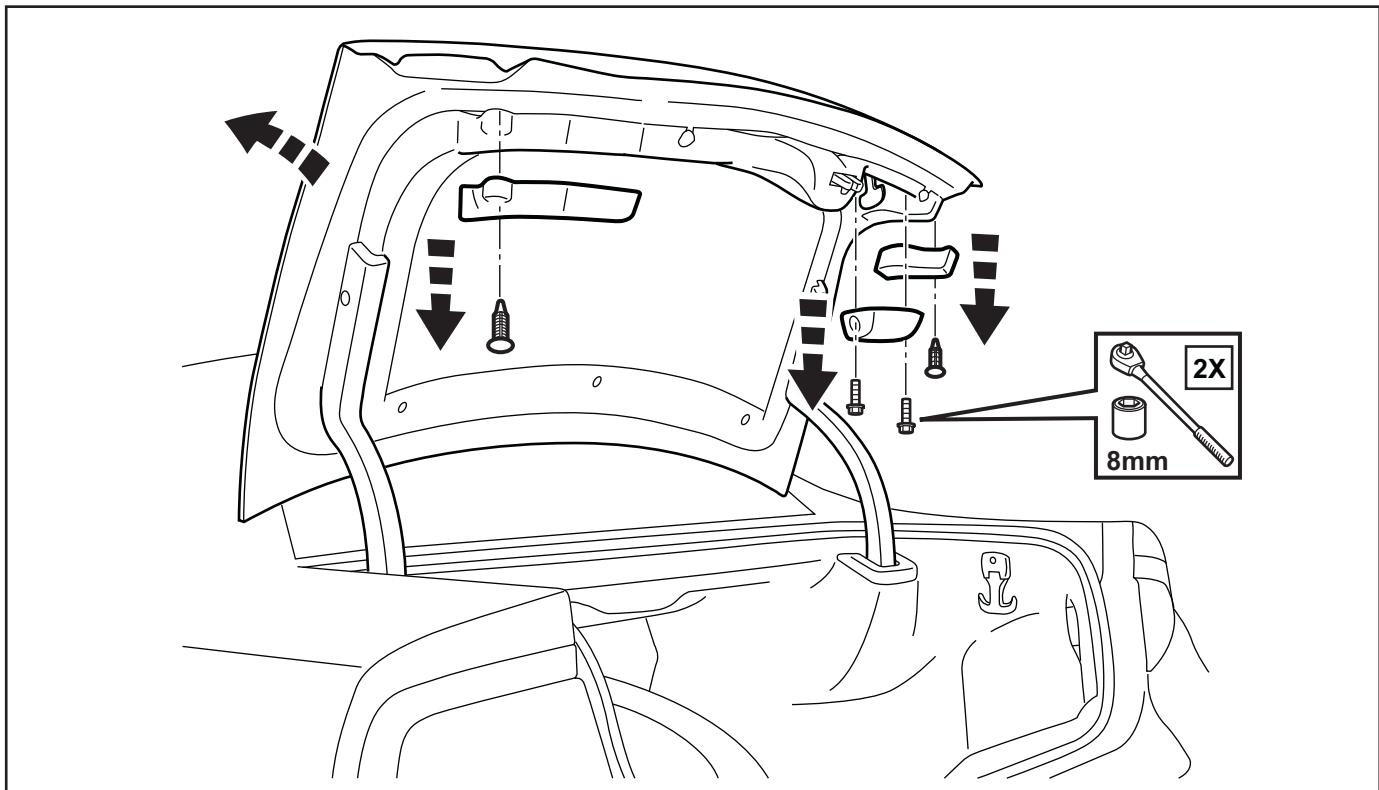
3. Quite los sujetadores y los broches de la mitad del revestimiento superior del maletero y desprenda con cuidado hacia abajo el revestimiento para obtener acceso a la lámina metálica del maletero. Identifique las aberturas en las esquinas derecha e izquierda a través de las cuales se posarán los orificios taladrados del deflector de aire. Conserve todas las piezas para efectuar la reinstalación.
