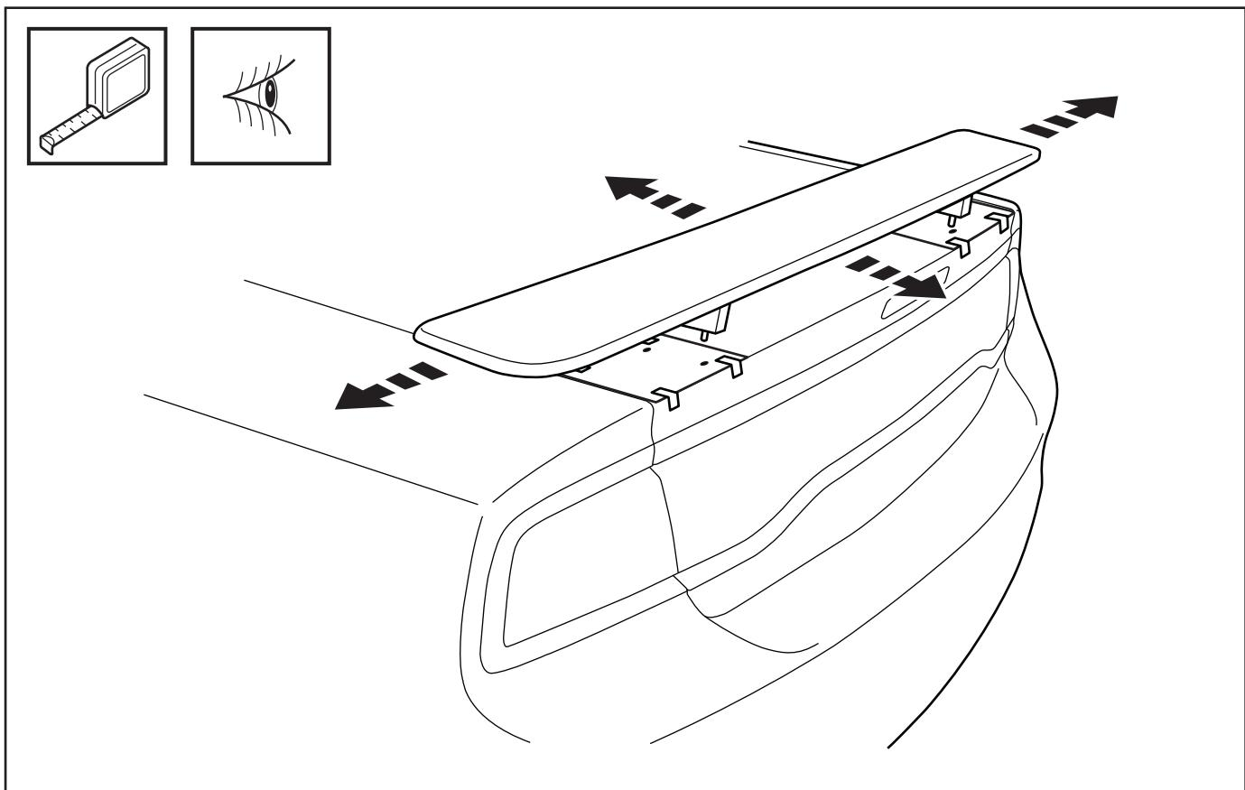
6. Indiquez la position des trous à l'aide d'un poinçon. Retirez les gabarits. Percez un trou de 7.94 mm (5/16") à chaque position indiquée. Utilisez un outil d'ébavurage pour nettoyer chaque trou. Traitez tous les trous avec un produit de scellement avant d'assembler l'aileron.
