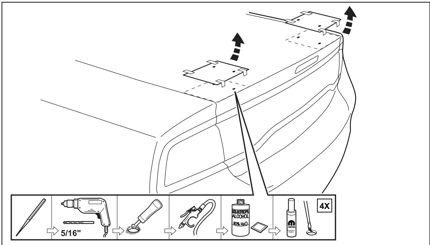
7. Placez l'aileron sur les trous d'assemblage et tenez en position. Ouvrez le coffre et attachez l'aileron de l'intérieur avec les (4) écrous d'assemblage de 10 mm. Serrez à 6 Nm (4,5 lb-pi.)
