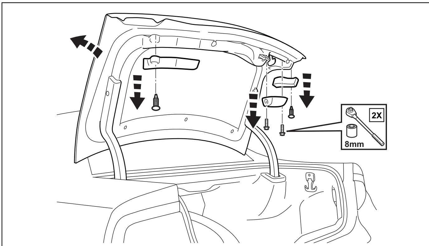
3. Retirez les attaches et les fixations de la moitié supérieure de la doublure du coffre et tirez délicatement la doublure vers le bas pour accéder au revêtement en tôle du coffre. Notez bien l'emplacement des trous de forage des coins gauche et droit. Conservez toutes les pièces pour la réinstallation.
