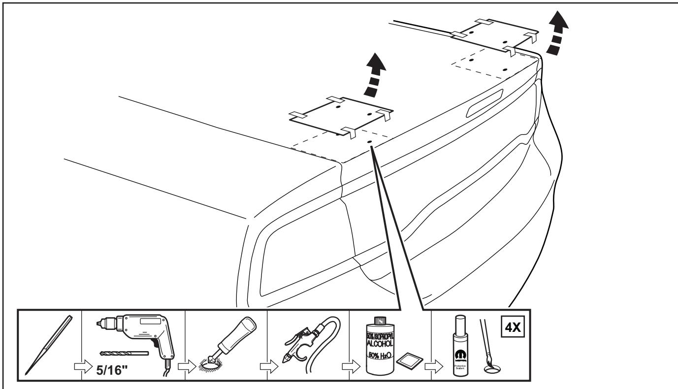
7. Coloque el deflector sobre los agujeros de montaje y sujetelo en su lugar. Abra la tapa del maletero y sujeté cuatro (4) tuercas de montaje de 10mm al deflector desde el lado interno. Apriete a 6 Nm (4.5 pies-lb)
