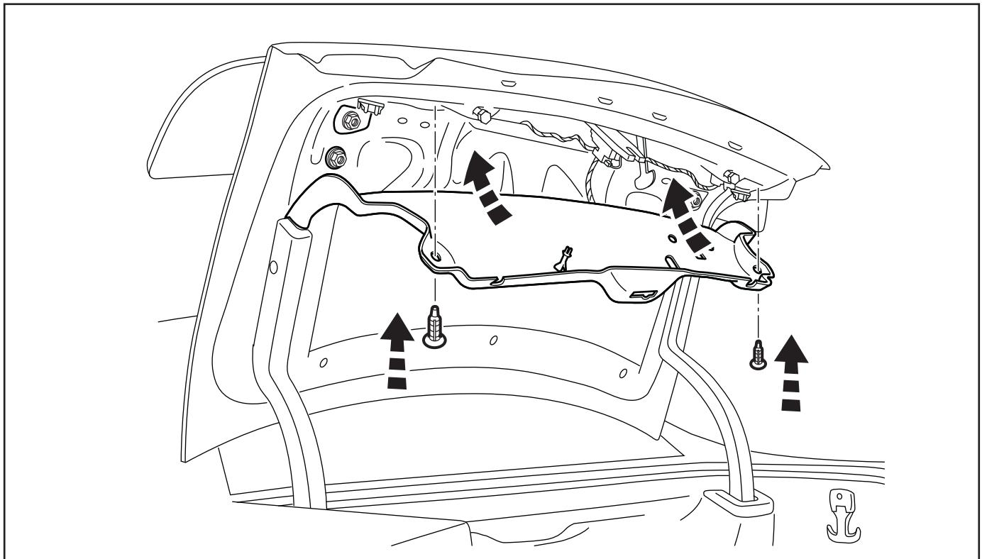
9. Réinstallez les couvercles de garniture des coins gauche et droit. Utilisez les (2) boulons de 8 mm pour réinstaller la poignée. Fermez le coffre.
