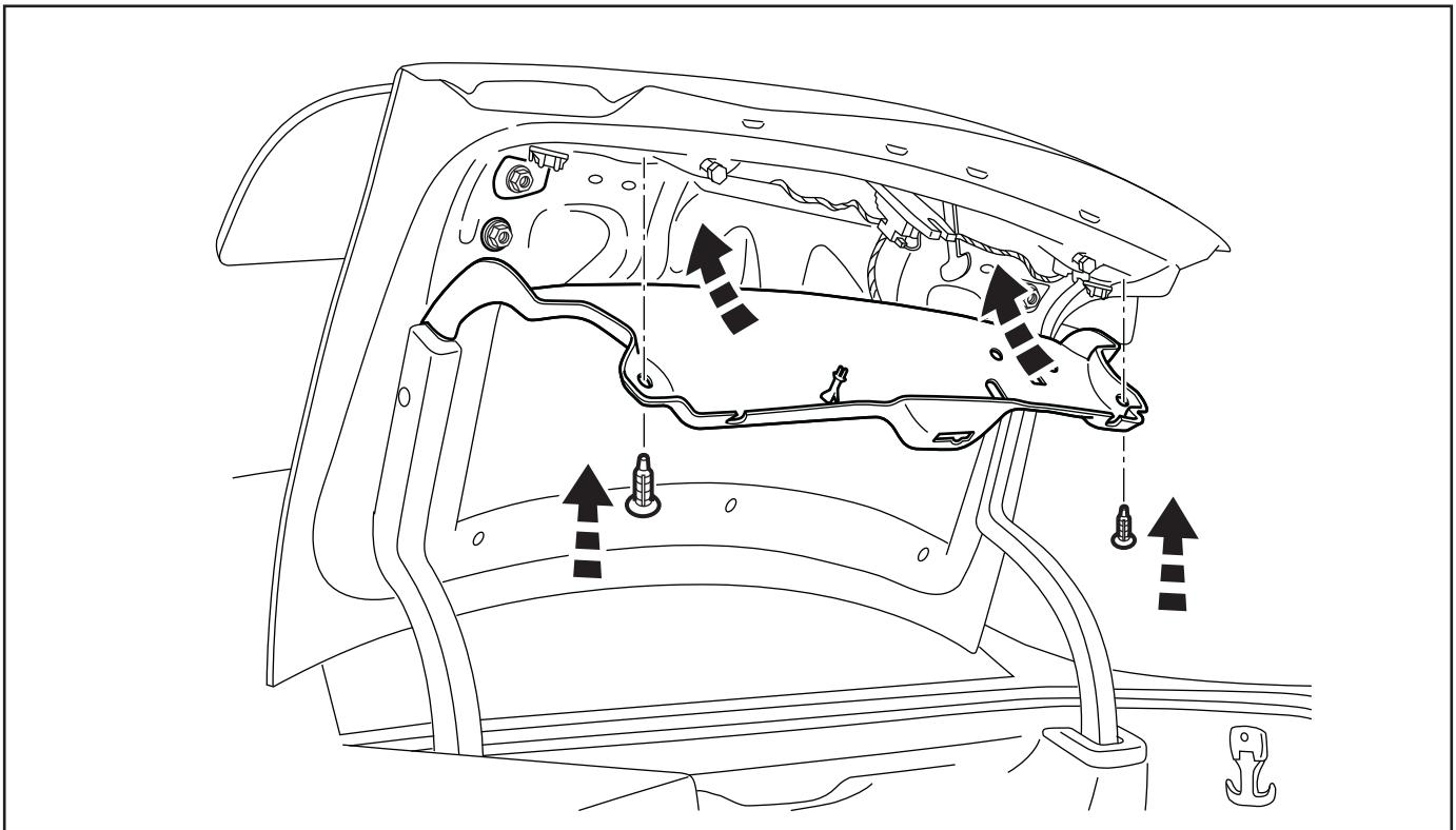
9. Reinstale las tapas de vestidura en las esquinas derecha e izquierda. Use dos (2) pernos de 8mm para instalar la agarradera. Cierre el maletero.
