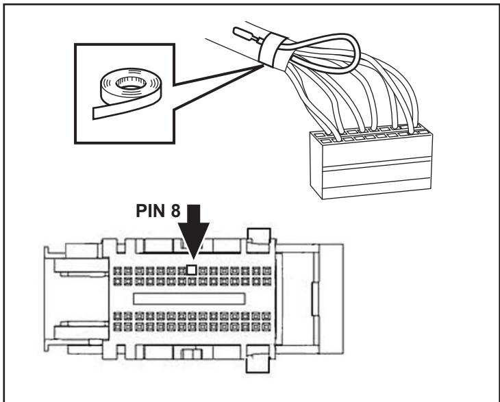
18. Inserte el conector de cable con lengüetas del mazo del interruptor (B) en la clavija 8 del conector.
