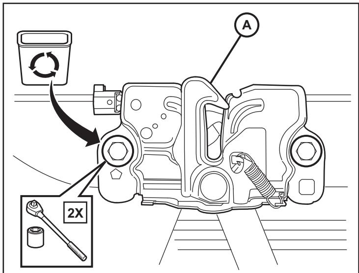
**NOTA:** Podría haberse instalado un mazo para el interruptor en la fábrica. De ser así, desprenda el conector, páselo por debajo del travesaño y conéctelo al conjunto de pestillo del capó, luego continúe con el Paso 20.
