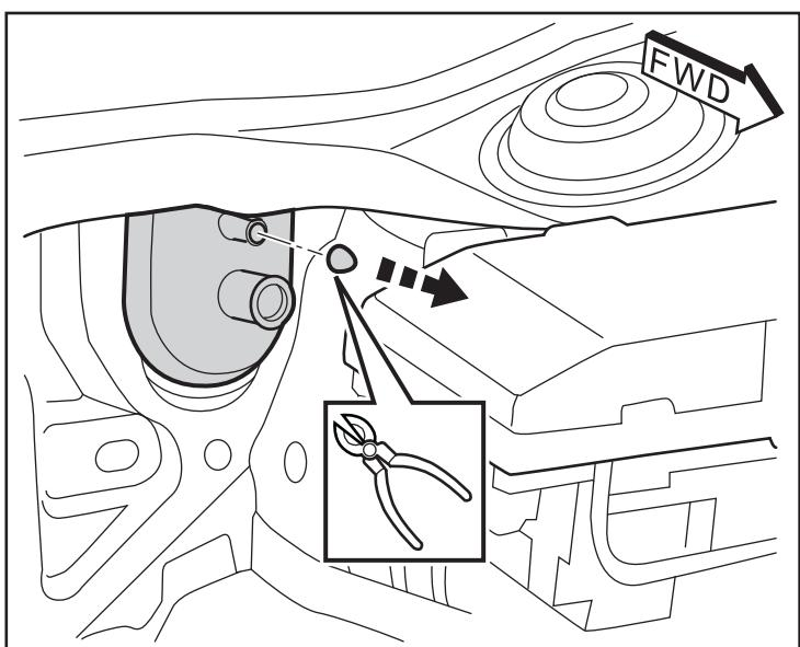
11. Retire con cuidado el panel de ajuste al final de la salpicadero en el lado del conductor. Retire con cuidado el panel inferior bajo la columna de dirección. Tire del arnés (B) hasta el interior.
