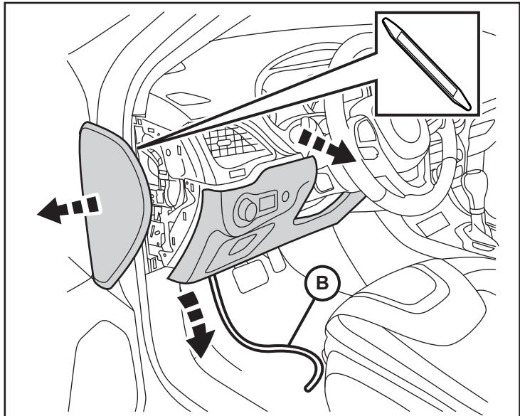
12. Quite los dos (2) tornillos de la palanca de apertura del cofre montaje y bajar el conjunto hacia abajo bajo la salpicadero.
