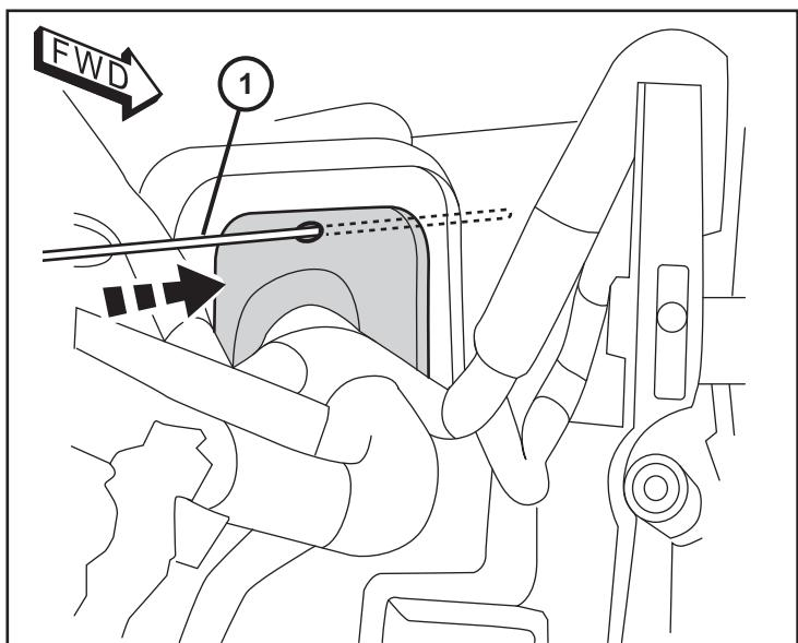
14. Fixer l'extrémité du fil (B) à la tige métallique avec un morceau de ruban adhésif. Tirer le faisceau de câbles par l'intermédiaire de l'intérieur du véhicule, sous le tableau de bord. Appliquer du RTV mastic pour le câblage électrique et tirez sur le faisceau de câbles dans le tube à sceller.
