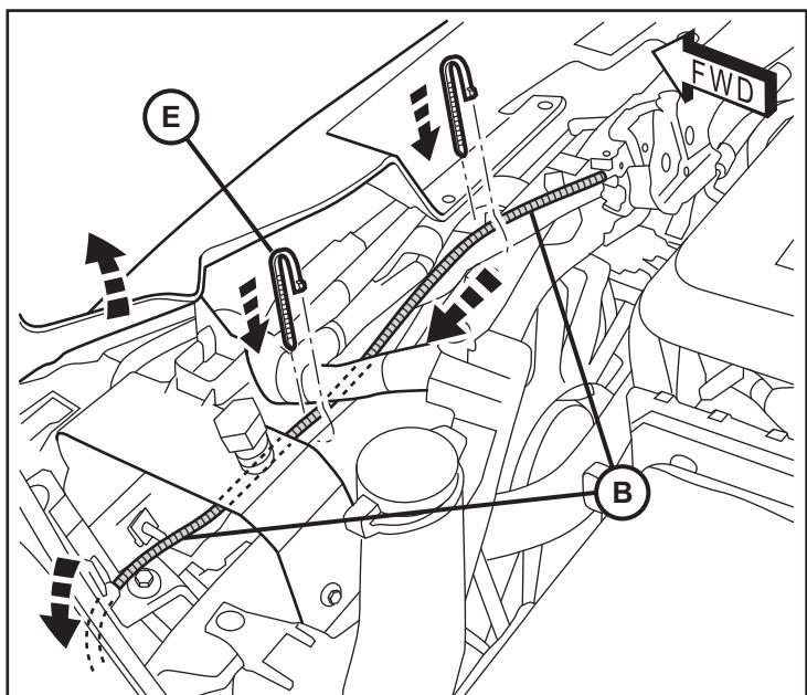
8. Faites passer le faisceau de câbles du commutateur (B), le long des faisceaux existants du véhicule vers le côté conducteur et puis vers l'arrière du compartiment moteur. Route fil derrière la boîte à fusibles.
