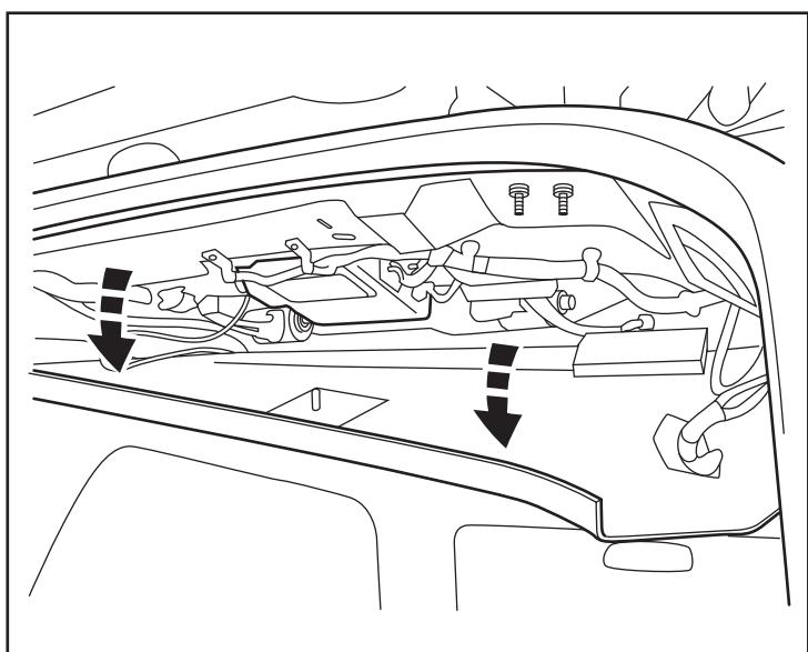
23. Localice el módulo de RF existente en el zona centro del techo. Desconecte todos los conectores del arnés. Quite los dos (2) elementos de fijación. Retire el Hub RF Módulo.
