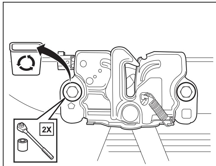
4. Desprenda con cuidado el panel de cubierta del radiador. Desconecte y retire el cable de liberación del pestillo del capó. Quite el conjunto del pestillo del capó.
