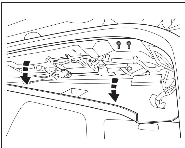
23. Localisez le module routeur RF existant. Débranchez tous ses connecteurs de faisceaux de câbles. Retirer les deux vis. Déposez le module routeur RF.
