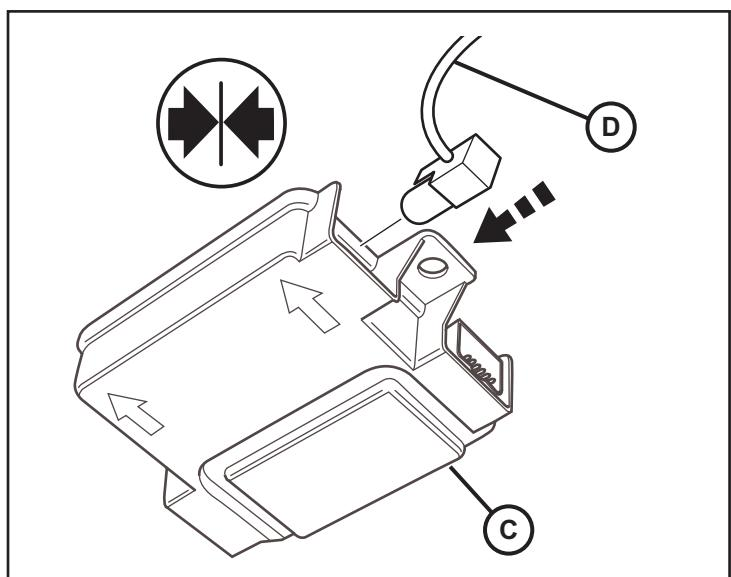
26. Placez le nouveau module routeur RF (C) en position. Fixez le module routeur RF au mur avec deux (2) vis et rebranchez tous les connecteurs de faisceaux de câbles.
