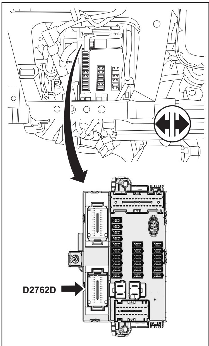
16. Separe del BCM el enchufe del conector superior izquierdo. Oprima las lengüetas de liberación en la parte trasera del conector y deslice el enchufe hacia afuera de la funda exterior.
