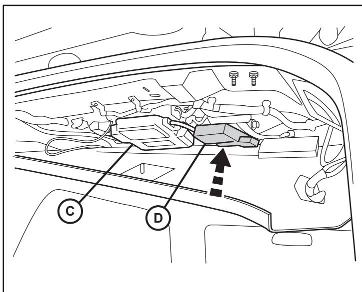
28. Revise todo los cables y recorte todos los sujetacables.
