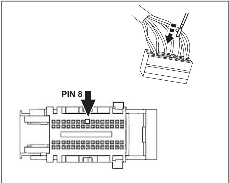
19. Vuelva a instalar la funda exterior sobre el conector. Enchufe todos los conectores al BCM.
