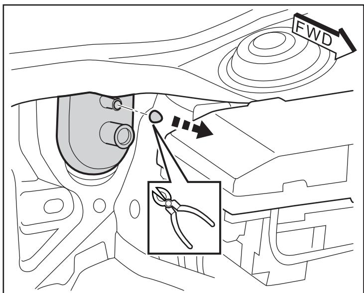
11. À l'aide de l'outil pour garnitures, déposez le capuchon d'embout du tableau du côté conducteur. Retirez le panneau de garniture inférieure sous la colonne de direction. Tirez le commutateur Harnais (B) à travers le plancher à l'intérieur.
