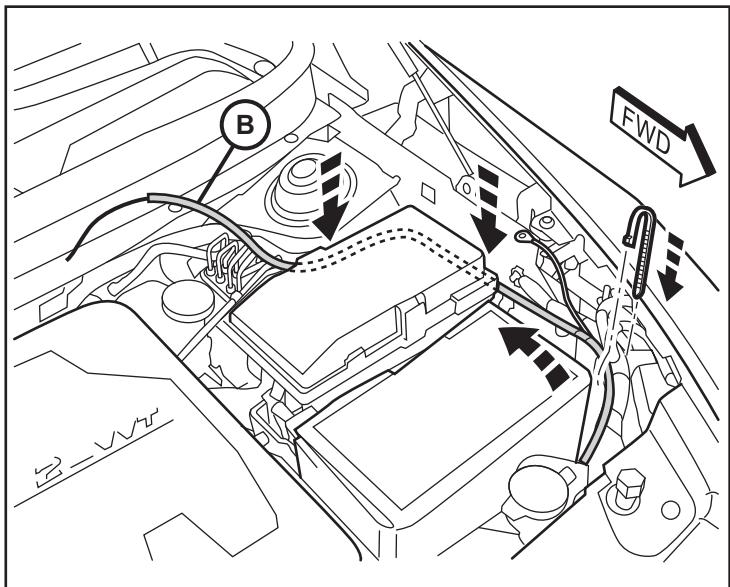
9. En el borde exterior próximo a la batería, retire la suelo existente tuerca para cable. Coloque el suelo anillo terminal del arnés principal (B) y vuelva a colocar la tuerca para fijarlo.
