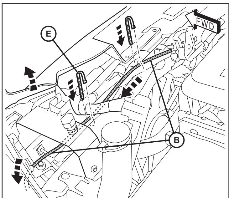
8. Encause el mazo del interruptor (B) junto con los mazos existentes en el vehículo sobre el lado del conductor y de regreso hacia la parte trasera del compartimiento del motor. Coloque el arnés detrás de la caja de fusibles, como se muestra.
