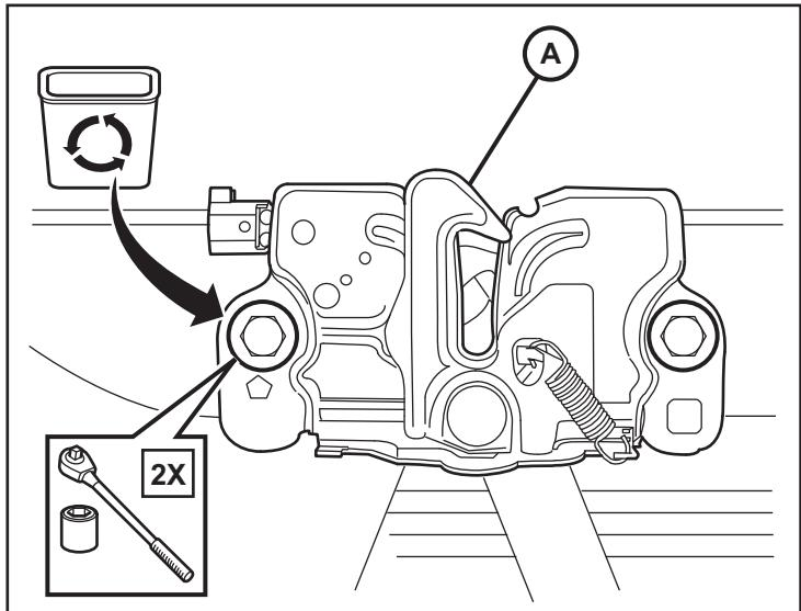
**REMARQUE :** Il se pourrait qu'un faisceau de câbles de commutateur d'origine soit présent. Si c'est le cas, détachez le connecteur, acheminez-le sous l'entretoise et branchez-le dans l'ensemble de verrouillage du capot, puis passez à l'étape 20.
