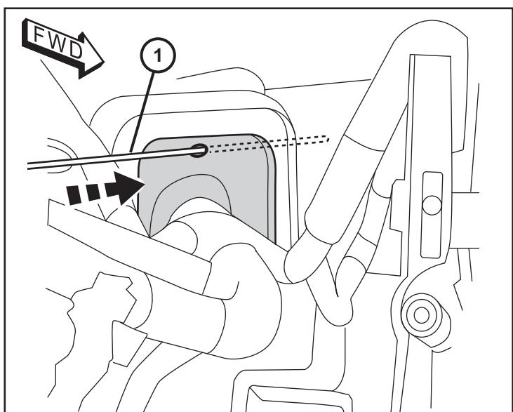
14. Asegure el extremo del mazo de cables al alambre de metal de largo con un trozo de cinta. Tire del extremo del arnés (B) a través de la parte interior debajo del tablero. Aplicar RTV sellador en el cableado y tire de los cables en el tubo para sellar el cableado en el tubo.
