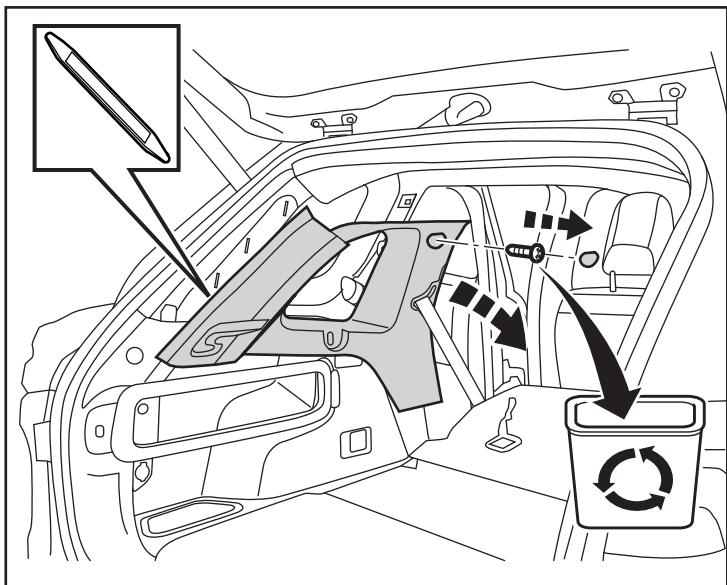
22. À l'aide d'un outil levier, dégagéz délicatement le panneau de garniture du toit à partir de l'ouverture du hayon.
