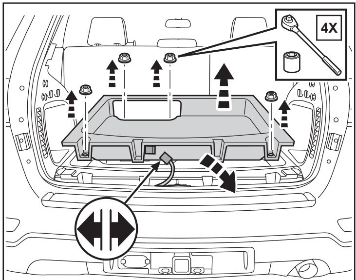
34. Retirez délicatement le panneau arrière de garniture inférieure sur le côté conducteur de la zone de hayon.
