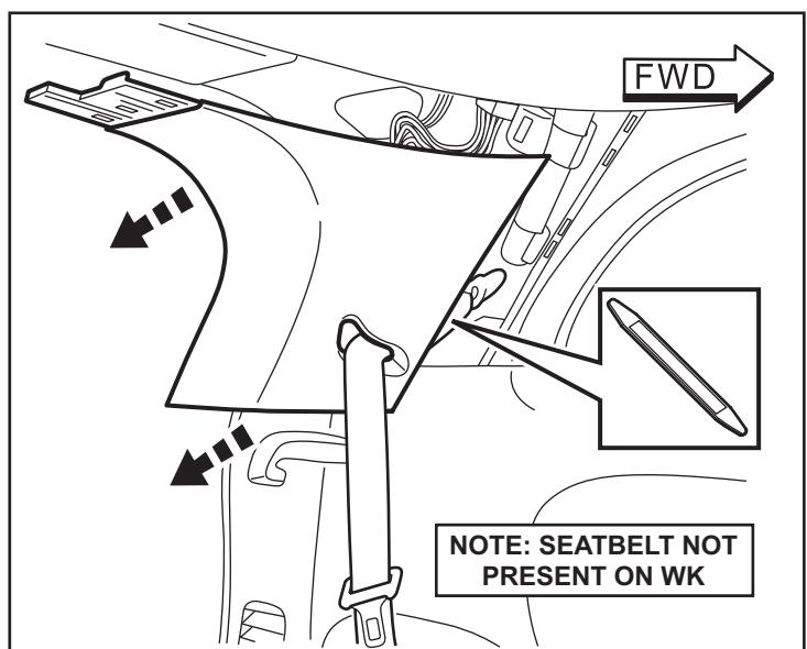
30. Quite dos (2) sujetadores del panel de estribo inferior. Retire el panel del vehículo.
