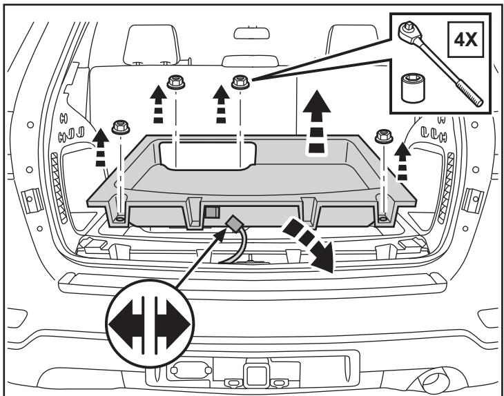
34. Haga palanca con cuidado hacia atrás el panel de ajuste inferior en el lado del conductor del área de puerta trasera.
