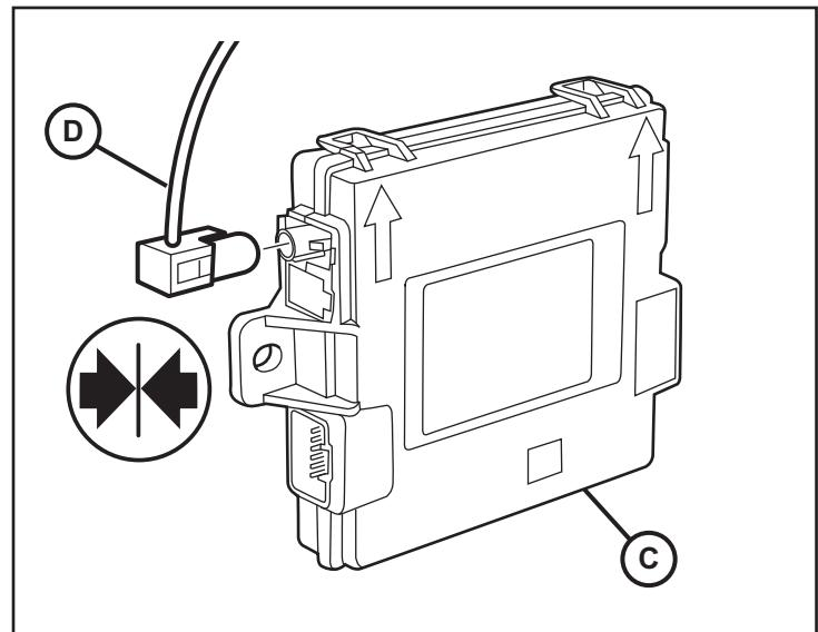
37. Placez le nouveau module routeur RF (C) en position. Fixez le module routeur RF au mur avec deux (2) écrous hex. (F) et rebranchez tous les connecteurs de faisceaux de câbles.
