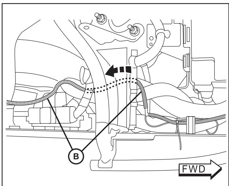
11. Ajuste cualquier soltura del mazo del interruptor (B) hacia la parte trasera del compartimiento del motor. Sujete junto con el arnés existente del vehículo utilizando sujetacables (E).
