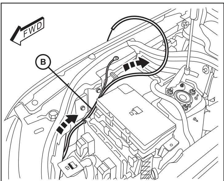
9. Dans le rebord intérieur de l'aile, dévissez l'écrou hexagonal long. Placez la cosse du fil de mise à la masse du faisceau de câbles du commutateur sur la tige filetée (B) et revissez solidement l'écrou.
