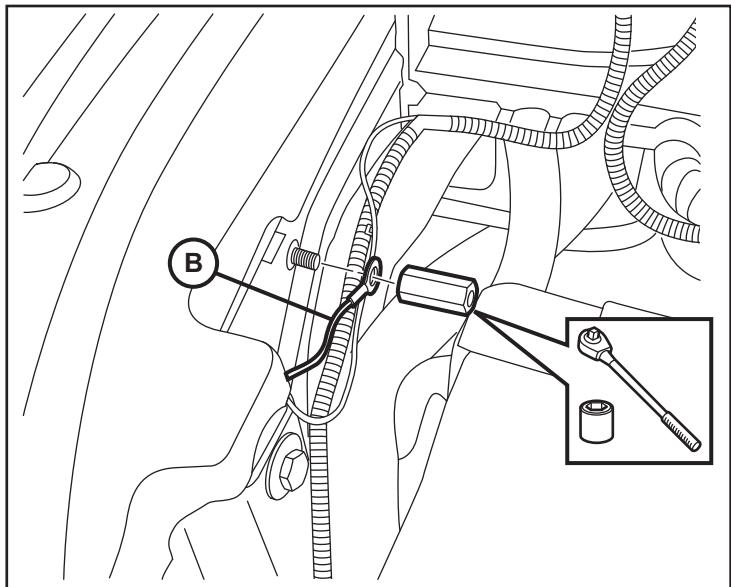
10. Encause el mazo del interruptor (B) por debajo del travesaño trasero y hacia afuera, cerca del terminal positivo de la batería.
