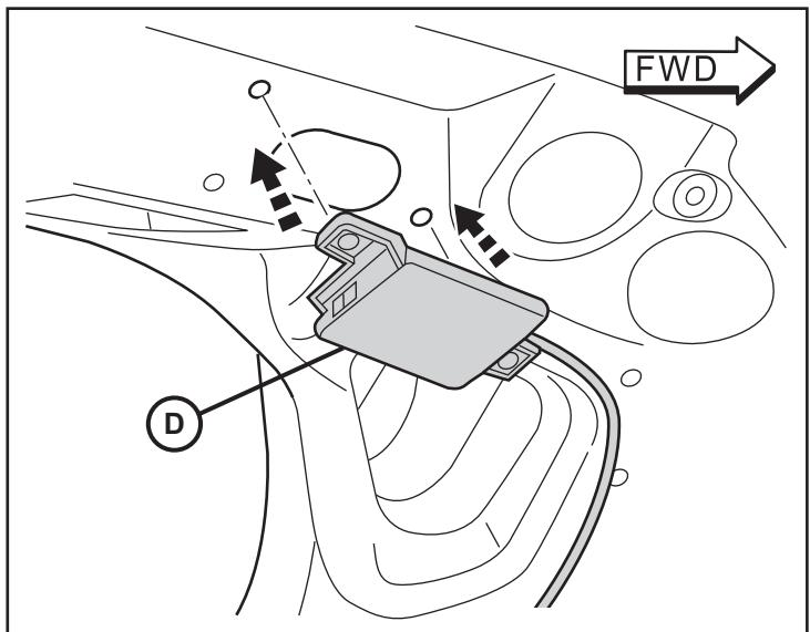
**41. Fijar la red de módulo de la antena (D) a lo largo del arneses de vehículos existentes en el interior del pilar trasero con ataduras de cables (E).**
