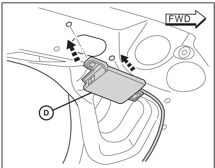
**41. Fixer le faisceau de module d'antenne (D) le long de la harnais de véhicules existant à l'intérieur du pilier arrière avec attaches de câble (E).**
