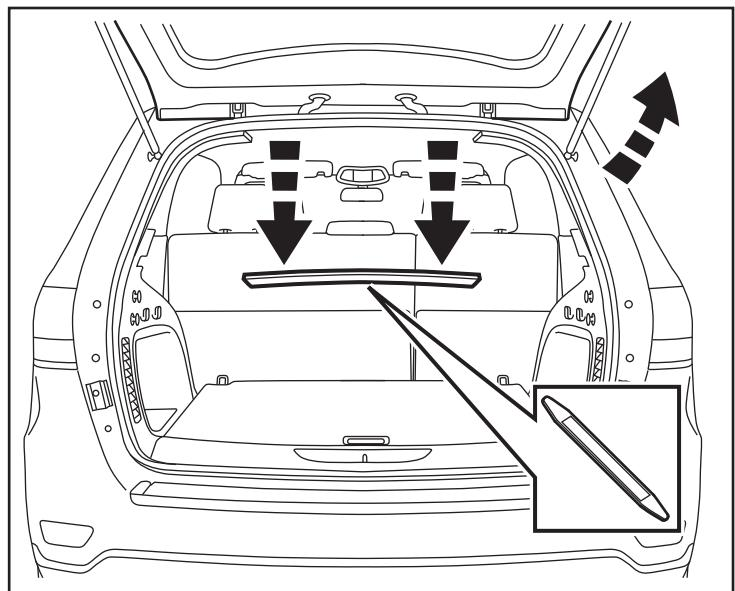
29. Retirez délicatement le panneau de garniture supérieure de la zone arrière de la trappe du côté du conducteur. Relâchez la sangle de sécurité à l'arrière du panneau et retirez le panneau du véhicule.
