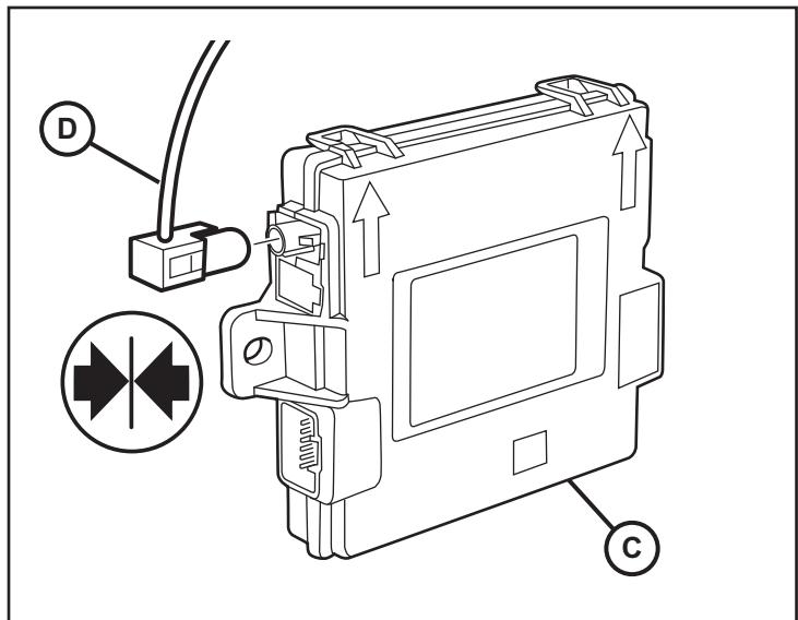
37. Coloque el nuevo Módulo de distribución RF (C) en su posición. Sujete el Módulo de distribución RF en la pared utilizando dos (2) tuercas hexagonales de sujeción (F) y vuelva a conectar todos los conectores de los mazos.
