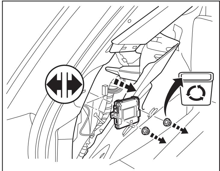
36. Enchufe el cable del Módulo de la antena (D) al nuevo módulo de distribución RF (C).
