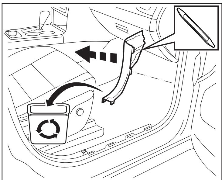
14. À l'aide de l'outil levier, déposez deux (2) attaches du panneau sous le coffre à gants. Débranchez les deux (2) connecteurs électriques se trouvant à l'arrière du panneau. Déposez le panneau.
