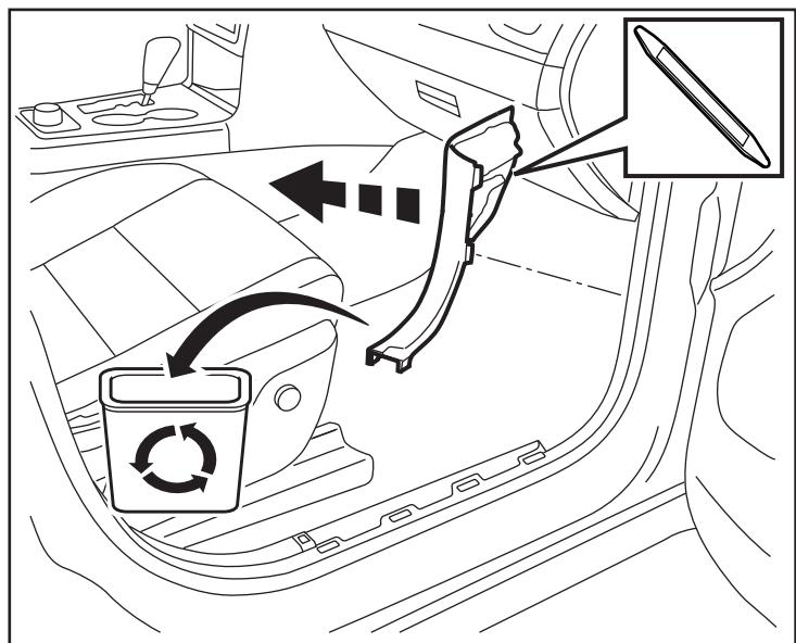
14. Utilice una herramienta para hacer palanca para quitar dos (2) sujetadores del panel de cubierta que se encuentra debajo de la guantera. Desconecte los dos (2) conectores eléctricos situados en el lado posterior del panel de cubierta. Retire el panel de cubierta.
