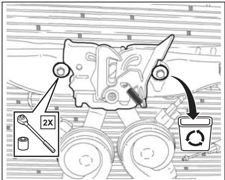
4. Soulevez délicatement le panneau recouvrant le radiateur. Débrancher et déposer le câble de déverrouillage du capot. Déposez l'ensemble de verrouillage du capot.
