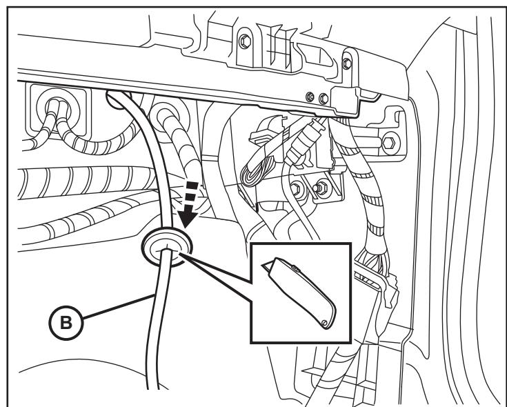
22. Localisez le module BCM de commande du châssis (Body Control Module) sous le coffre à gants ou sur la paroi extérieure du puits de jambe côté passager. Vous devrez accéder au connecteur **D3806A** en haut à gauche pour y raccorder le nouveau faisceau de câbles. Pour obtenir suffisamment de jeu dans le faisceau de câbles du BCM, débranchez tous les connecteurs du module et tirez délicatement le faisceau vers le bas.
