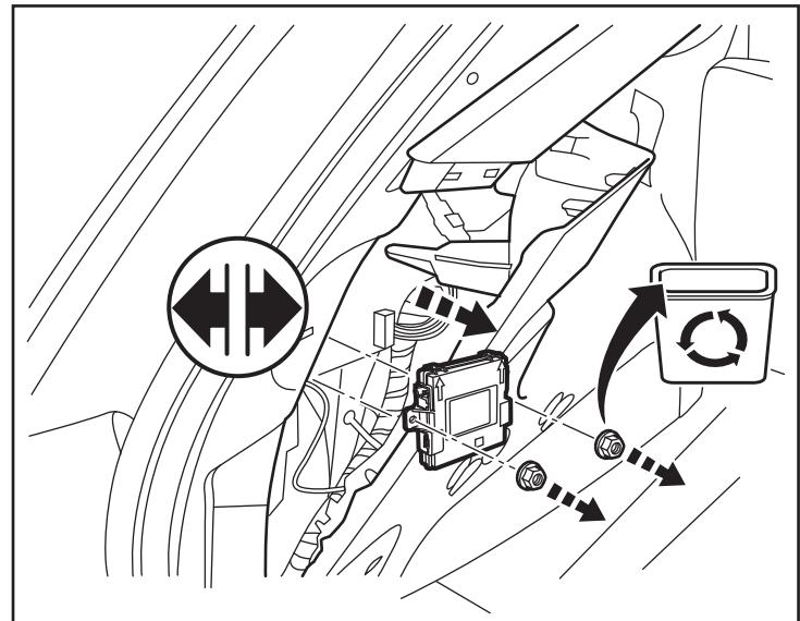
36. Branchez le câble du module d'antenne (D) dans le nouveau module routeur RF (C).
