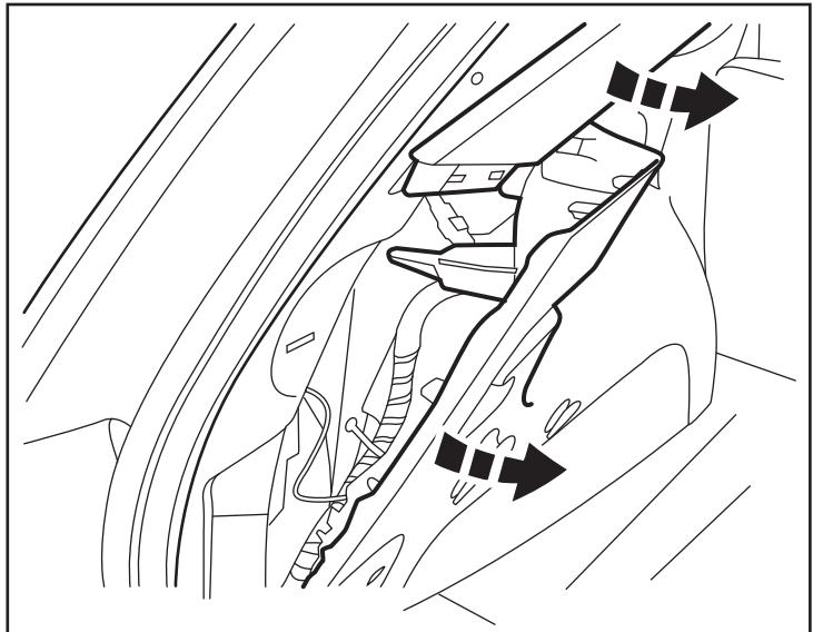
35. Localice el módulo de distribución RF existente en el poste del lado del conductor del área de la compuerta trasera. Desconecte todos los conectores de los mazos. Quite dos (2) tuercas de sujeción hexagonales. Retire el módulo de distribución RF.
