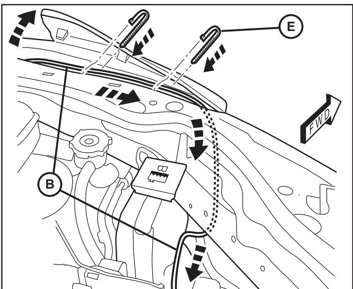
8. Faites passer le faisceau de câbles du commutateur (B), le long des faisceaux existants du véhicule vers le côté passager et puis vers l'arrière du compartiment moteur.
