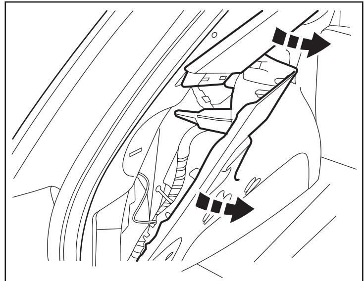
35. Localisez le module routeur RF existant sur le montant du hayon arrière côté conducteur. Débranchez tous ses connecteurs de faisceaux de câbles. Déposez deux (2) écrous hex. de montage. Déposez le module routeur RF.
