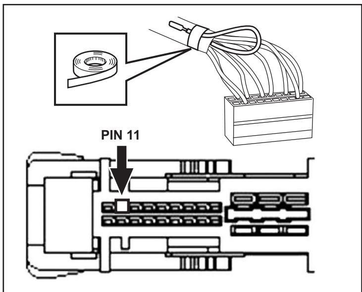
25. Inserte el conector de cable con lengüetas del mazo del interruptor (B) en la clavija 11 del conector.
