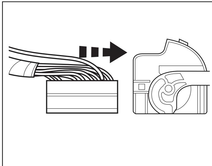
27. Reposez le passe-câble caoutchouté sous le tableau de bord. Appliquez du scellant RTV sur l'incision faite dans la membrane du passe-câble pour prévenir tout échange d'air. Repliez sur lui-même tout excès de longueur du faisceau de câbles sous le tableau de bord et attachez le tout avec un serre-câble.
