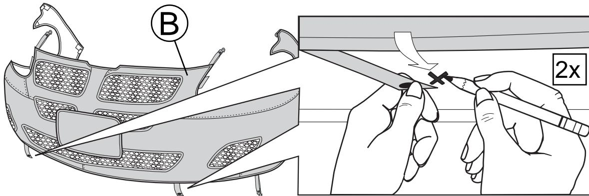
**GB** MAKE SURE COVER IS PULLED DOWN INTO POSITION BEFORE MARKING THE LOWER SNAP LOCATIONS
