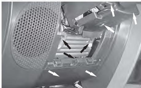
C. Retirez le panneau de tableau de bord en plastique inférieur. Le panneau est retenu par des clips.
