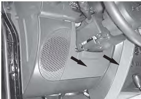
B. Retirez (3) boulons maintenant le panneau métallique en place. Tirez sur le panneau pour le retirer.
