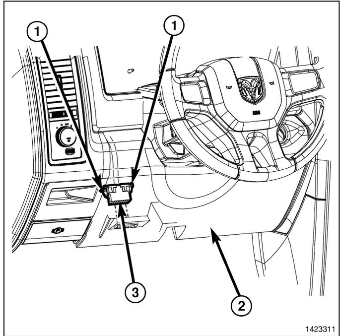
4. Con una herramienta de punta plana C-4755 o una equivalente, suelte los clips de retención que fijan la cubierta de la apertura de la columna de la dirección (1) al panel de instrumentos y retire la cubierta.
