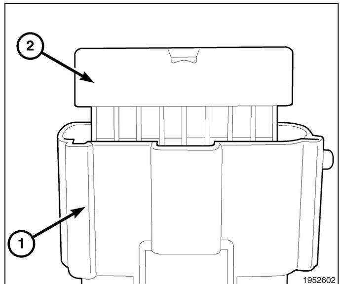
22. Localiser la fente/cavité 3 (G70 circuit) de la borne (3) sur le côté jumelé à la gaine du connecteur.
