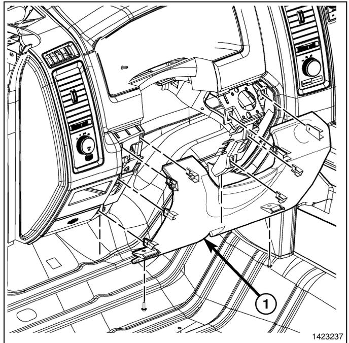
5. Monte el conector de diagnóstico (3) en la cubierta de la apertura de la columna de la dirección (2). Para ello, empuje el conector por la apertura en la parte trasera de la cubierta y acople por completo las lengüetas de bloqueo (1) del conector.
