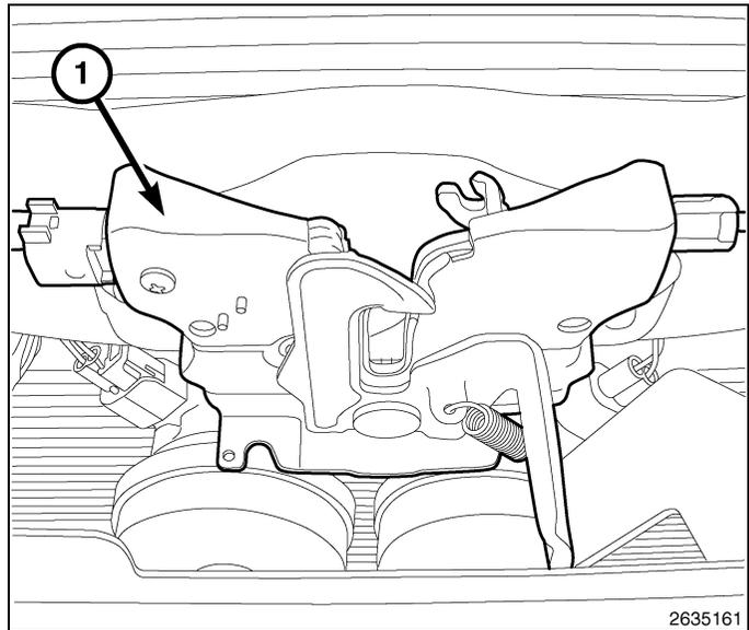
**NOTE:** Es posible que haya un mazo de cables del conmutador del capó de fábrica no utilizado encintado al mazo de cables del vehículo existente. Dicho mazo de cables está situado detrás del radiador, justo debajo del travesaño superior del radiador. Si lo encuentra, suéltelo, páselo debajo del travesaño del radiador, a través del conjunto del pestillo del capó y conéctelo. En caso de que no encuentre el mazo de cables del conmutador del capó de fábrica, siga los pasos del 9 al 32.
