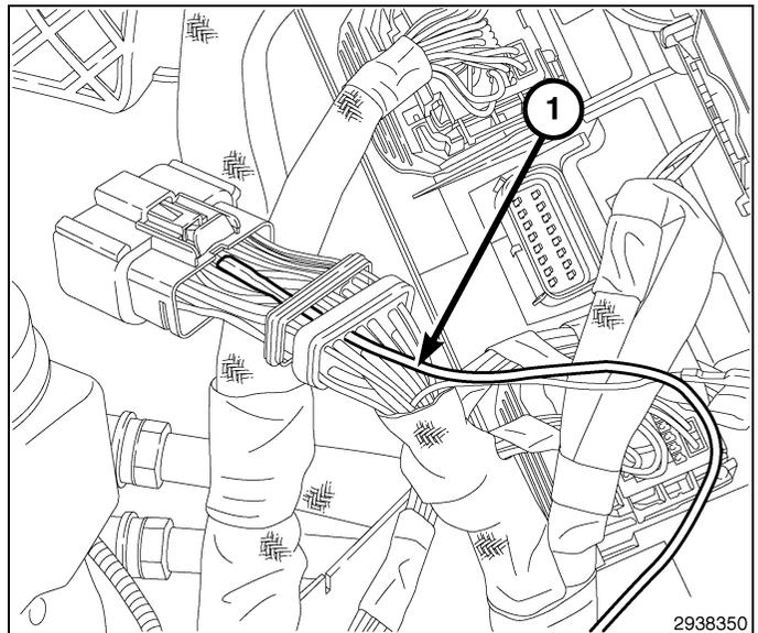
**NOTE: Los conectores eléctricos del módulo de alimentación totalmente integrada están identificados con colores diferentes para facilitar su ubicación.**
