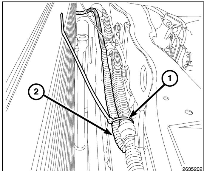
12. Acheminer le faisceau du commutateur de capot (1) sous le support de montage du radiateur vers la face interne de l'aile gauche. Bien fixer le faisceau de commutateur de capot (2) au besoin au faisceau du véhicule existant à l'aide des serre-câbles (1) inclus dans la trousse.
