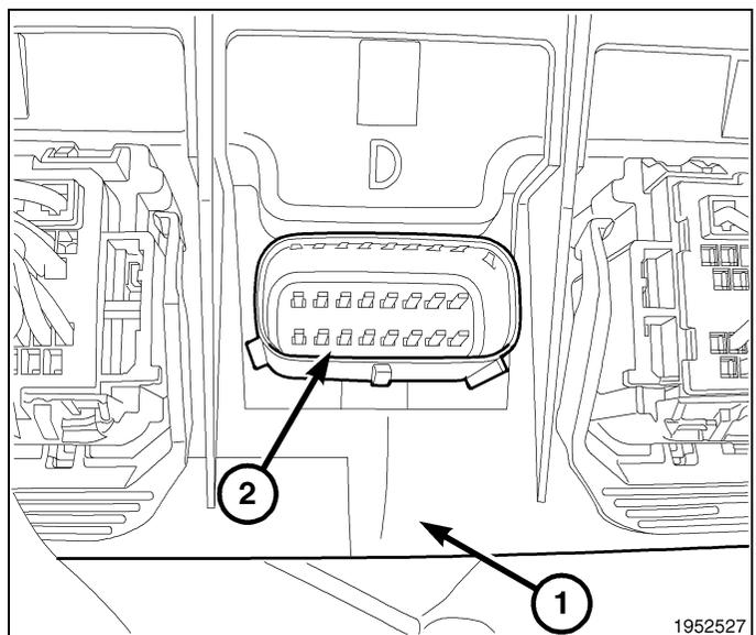
18. Coloque los cables en espiral bajo el mazo de cables que va al TIPM y fíjelos donde sea necesario.
