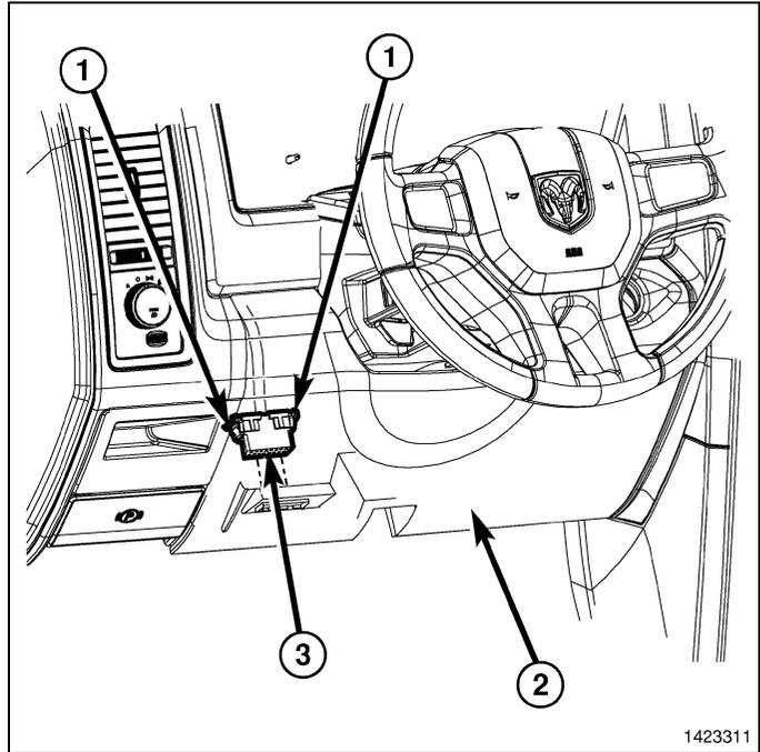
4. À l'aide d'une baguette de garnissage C-4755 ou d'un outil équivalent, dégager les agrafes de retenue qui fixent le couvercle de l'ouverture de la colonne de direction (1) au tableau de bord et retirer le couvercle.
