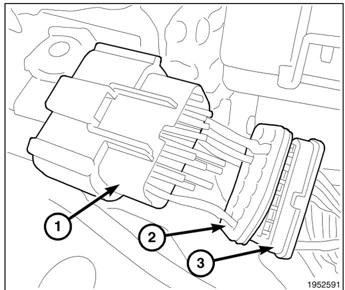
21. Retirer la partie avant du connecteur à partir du boîtier de connecteur. Cette partie du connecteur s'aligne correctement avec les bornes à l'intérieur du boîtier de connecteur.
