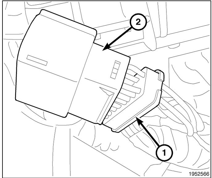
20. Retire la junta hermética de la parte trasera del conector.
