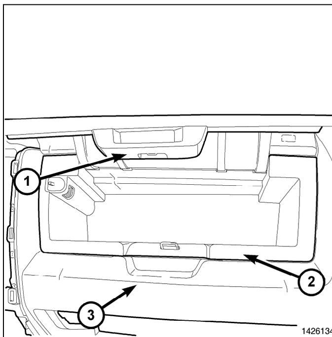
**NOTE: L'antenne WIN est située derrière le côté gauche du casier de rangement.**
