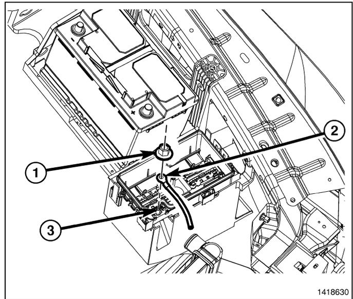
30. Installer la mise à la masse du faisceau de câblage en queue de cochon (2) à l'aile sous la mise à la masse de la carrosserie (4).
