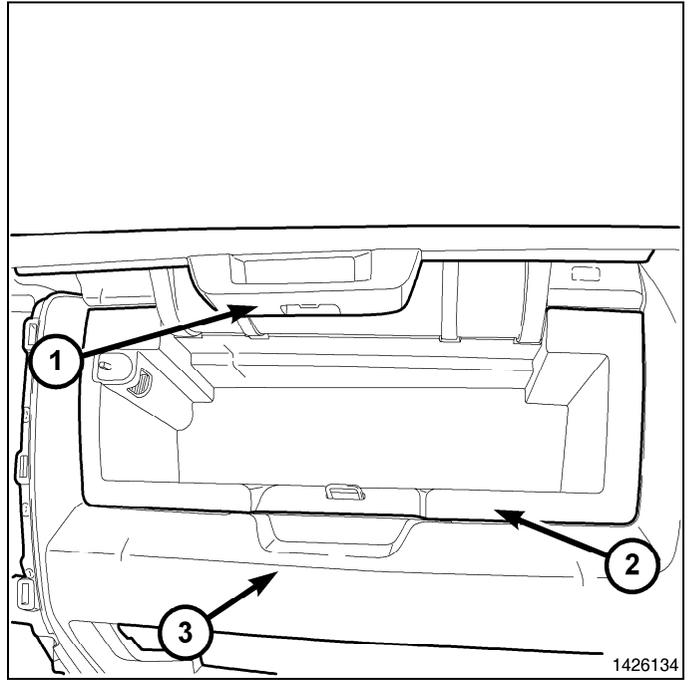
15. A través de la apertura de la guantera, monte el elemento de fijación del compartimento de almacenamiento (2) en la parte trasera de dicho compartimento (1).
