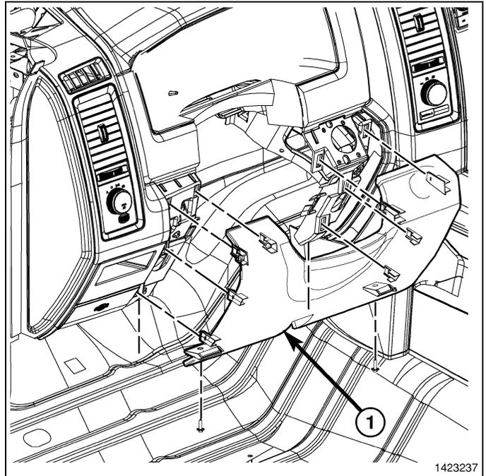
5. Installer le connecteur de diagnostic (3) au couvercle de l'ouverture de la colonne de direction (2) en poussant le connecteur au travers de l'ouverture de la face arrière du couvercle et engager complètement les languettes de blocage (1) du connecteur.
