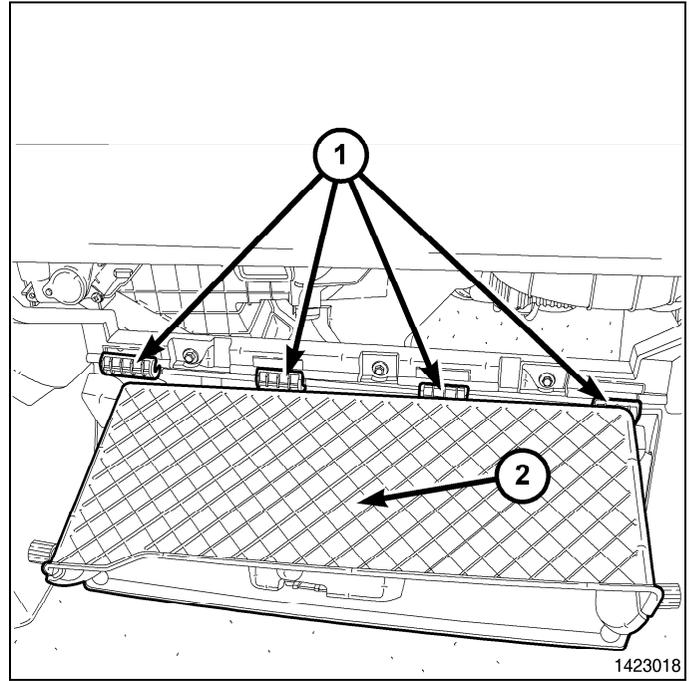
4. A través de la apertura de la guantera, retire el elemento de fijación del compartimento de almacenamiento (2) situado en la parte trasera de este compartimento (1).
