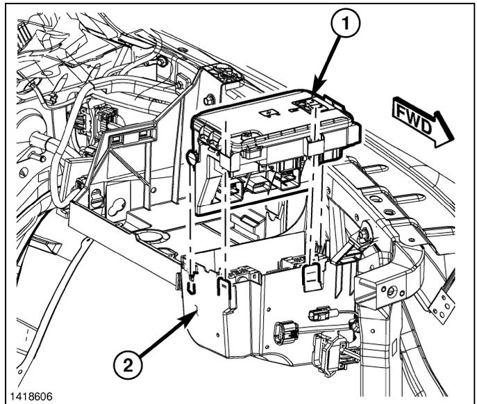
17. Desenchufe el conector C4, etiquetado con la letra D en la parte inferior del TIPM. Libérela haciendo presión en la lengüeta de bloqueo y girando el brazo del conector hacia afuera hasta que se suelte del conjunto del TIPM (1). Asegúrese de que el conector se ha retirado por completo.
