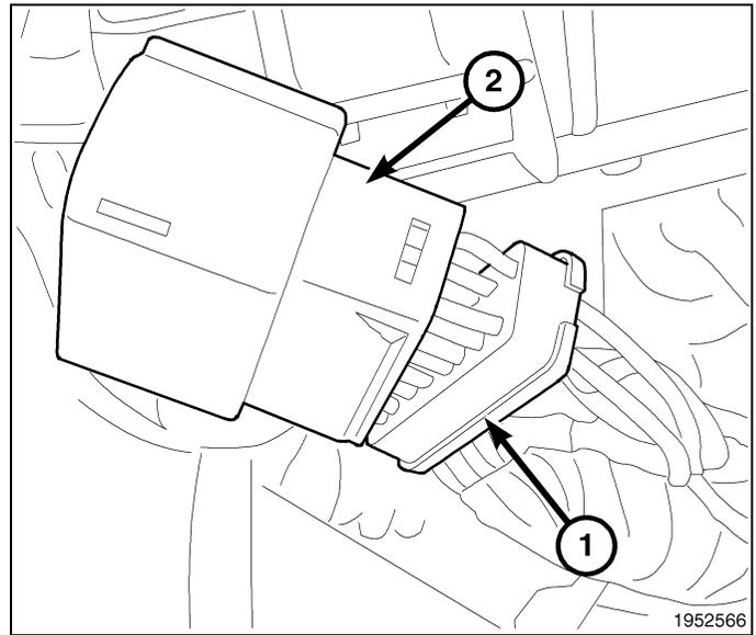
20. Retirer le joint d'étanchéité de l'arrière du connecteur.
