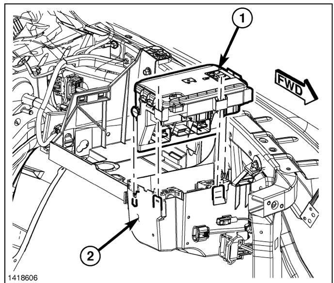
17. Débrancher le connecteur C4, étiqueté par la lettre D au bas du TIPM. Desserrer en enfonçant la languette de blocage et en tournant le bras du connecteur vers l'extérieur, jusqu'à ce que le connecteur soit dégagé du TIPM (1). S'assurer de tirer le connecteur en ligne droite.
