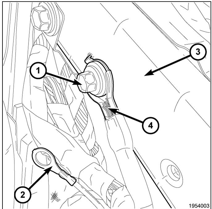
14. Retirer l'écrou de borne de tension positive de la batterie (1) de la borne de tension positive de la batterie raccordée au module d'alimentation électrique totalement intégrée (3) (TIPM). Retirer le câble de tension positive de la batterie (2) du module d'alimentation électrique totalement intégrée.
