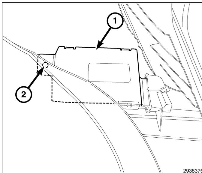
12. Monte de forma parcial el compartimento de almacenamiento y enchufe el conector eléctrico de la luz del compartimento de almacenamiento.
