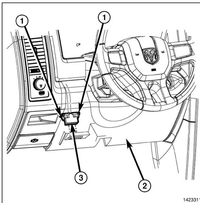
6. Installer les deux attaches (2) qui fixent le couvercle d'ouverture de la colonne de direction (1) au tableau de bord.
