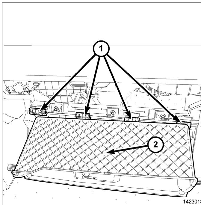
17. Appuyer vers le bas sur le rebord arrière de la boîte à gants (2) et soulever la boîte à gants par-dessus les deux butées (1).
