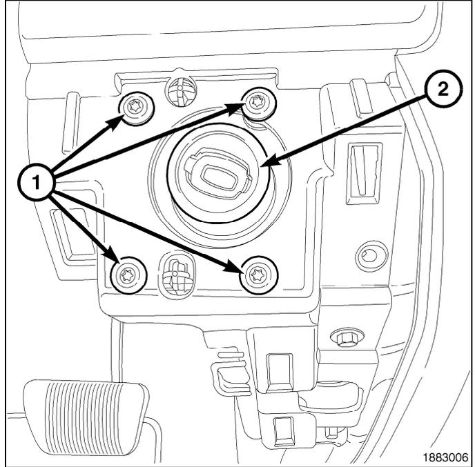
4. Positionner le couvercle de l'ouverture de la colonne de direction (2) au tableau de bord et engager complètement les agrafes de retenue au tableau de bord.
