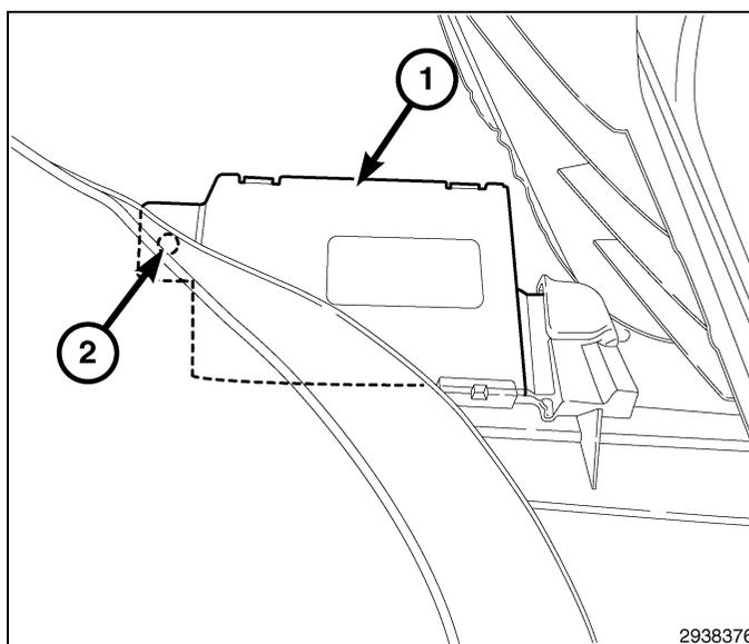
12. Installer partiellement le casier de rangement et brancher le connecteur électrique de la lampe du casier de rangement.
