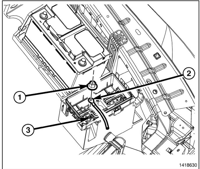
30. Monte la conexión a masa del mazo de cables en espiral (2) a la aleta debajo de la conexión a masa de la carrocería (4).
