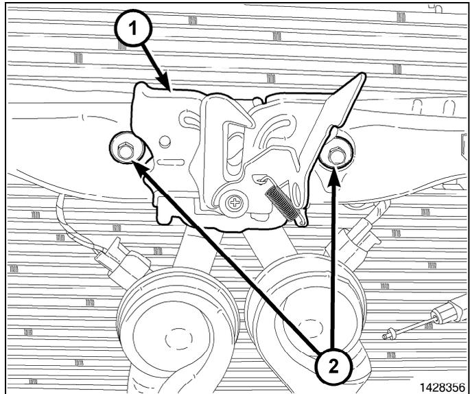
5. Débrancher le câble du loquet de capot (1) du loquet de capot (5) et déposer le loquet.
