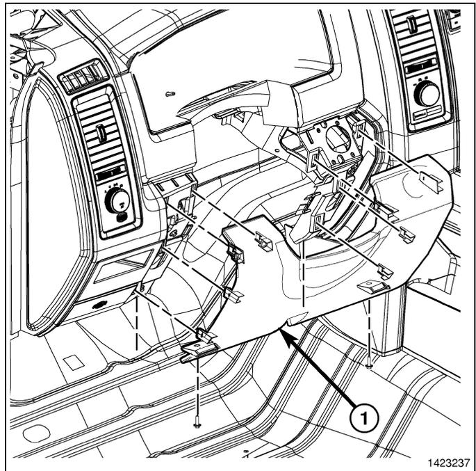
5. Retire los cuatro elementos de retención del WIN (1).
