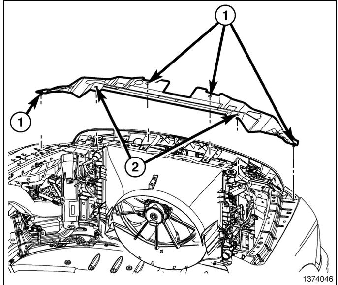
3. Utilizando un lápiz de cera o equivalente, marque la posición del pestillo del capó (1) en el travesaño superior del radiador.
