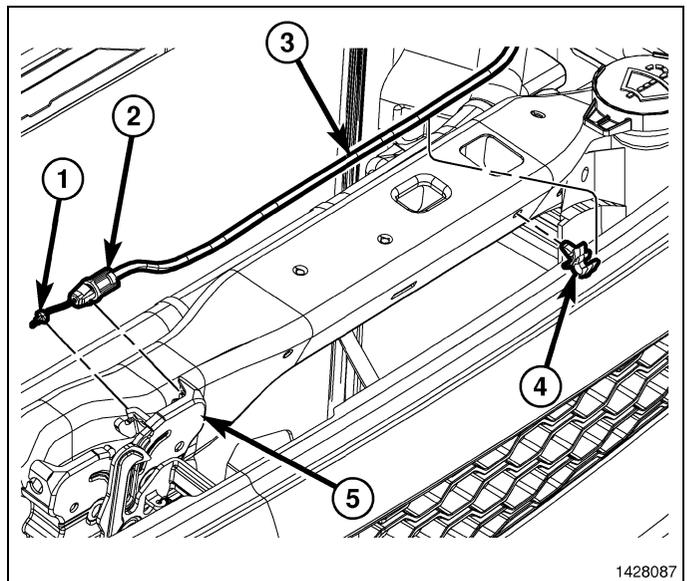
6. Conecte el cable del pestillo del capó al conjunto de pestillo del capó (1).
