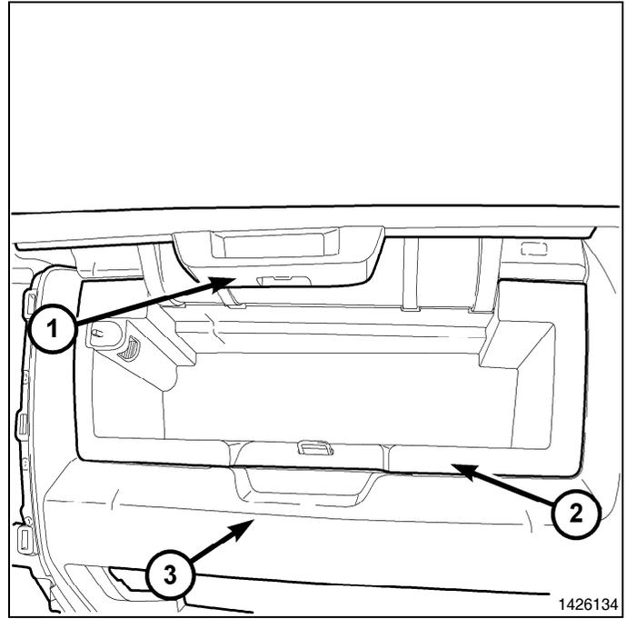
15. Par l'ouverture de la boîte à gants, installer l'attache du casier de rangement (2) à l'arrière du casier (1).
