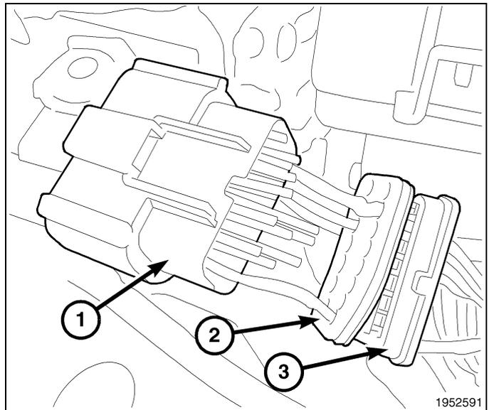
21. Retire la parte delantera del conector del alojamiento del conector. Esta parte del conector se alinea con los terminales correctamente dentro del alojamiento del conector.
