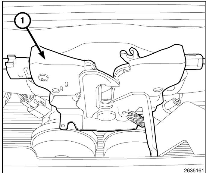
**NOTE: On peut trouver un faisceau de commutateur de capot posé en usine et attaché sur le faisceau existant du véhicule situé derrière le radiateur juste dessous la traverse supérieure du radiateur. Si c'est le cas, le détacher, l'acheminer sous la traverse du radiateur à travers l'ensemble de verrou du capot et le connecter. En l'absence de faisceau de commutateur pose en usine, suivre les étapes 9-32.**
