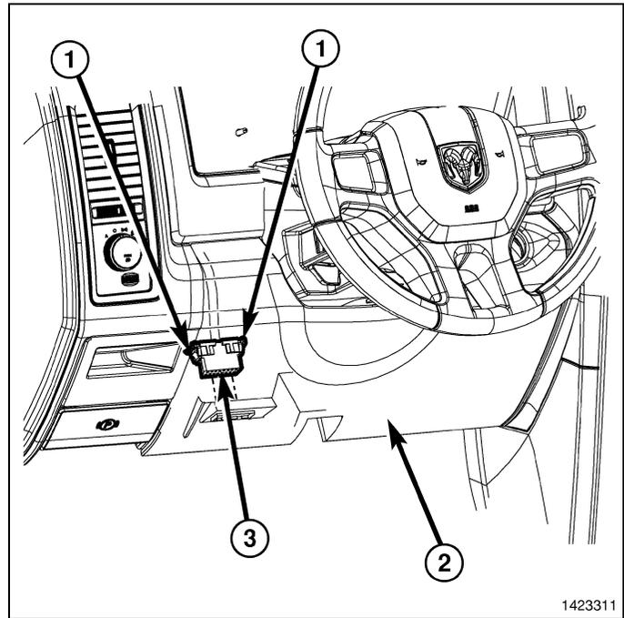
6. Monte los dos elementos de fijación (2) que fijan la cubierta de la apertura de la columna de la dirección (1) al panel de instrumentos.
