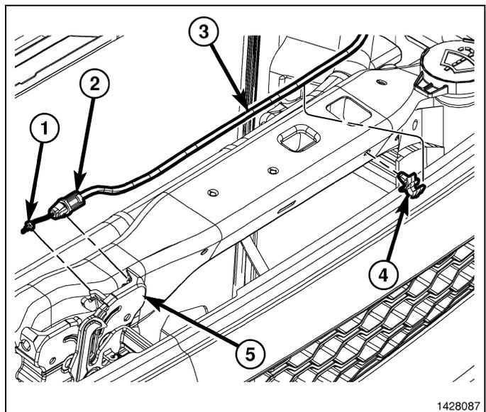
6. Brancher le câble de loquet du capot à l'ensemble de loquet de capot (1).
