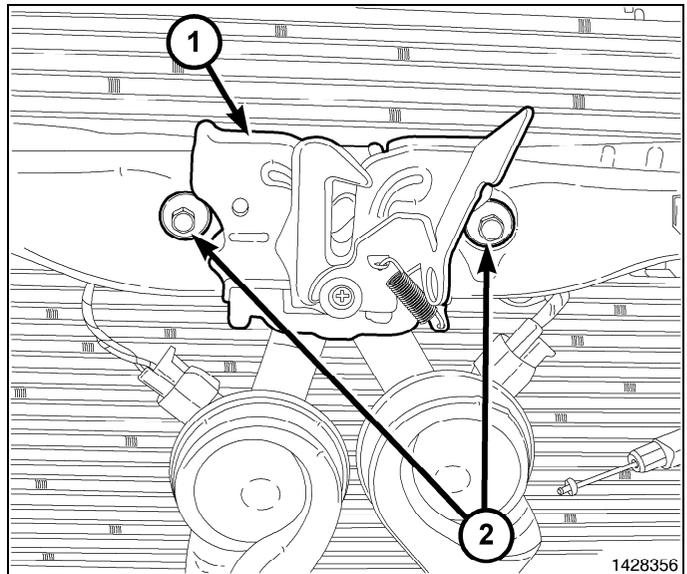
5. Desconecte el cable del pestillo del capó (1) del pestillo del capó (5) y extraiga el pestillo.
