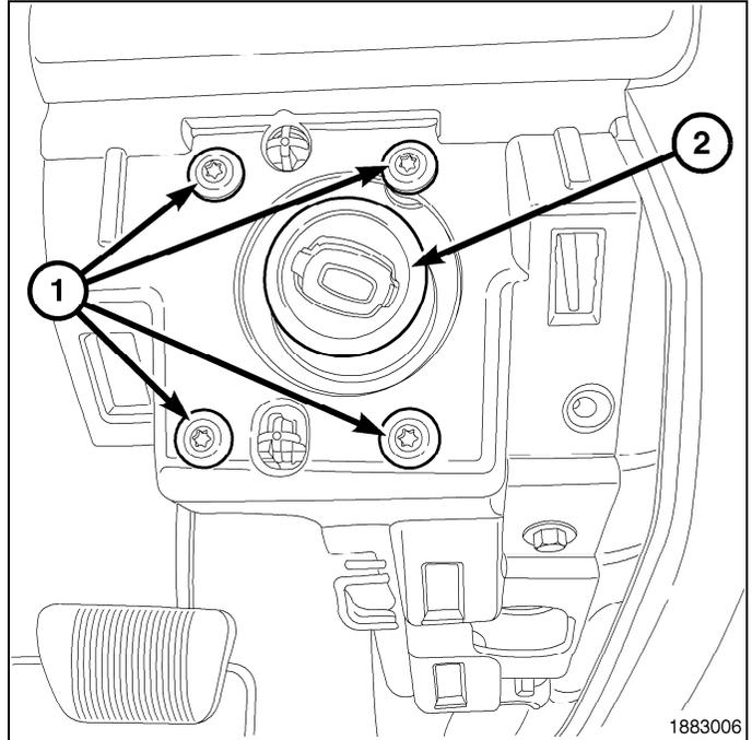
4. Coloque la cubierta de la apertura de la columna de la dirección (2) en el panel de instrumentos y acople por completo los clips de retención en el panel de instrumentos.
