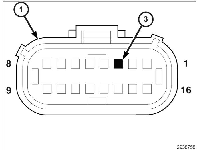
23. Coloque el cable púrpura/blanco (1) desde el mazo de cables del conmutador del capó a través del bloqueo secundario, por el burlate y en la ranura del terminal 3 (circuito G70) del lado del cableado del alojamiento del conector.
