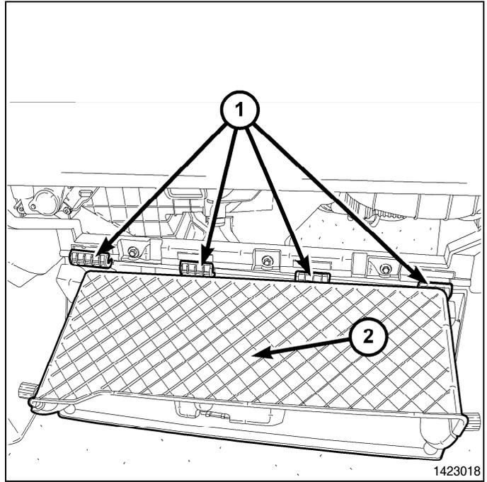
4. Par l'ouverture de la boîte à gants, retirer l'attache du casier de rangement (2) située à l'arrière du casier de rangement (1).
