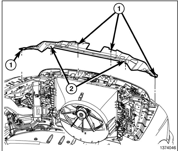
3. À l'aide d'un crayon gras ou l'équivalent, marquer la position du loquet de capot (1) sur la traverse de radiateur supérieure.
