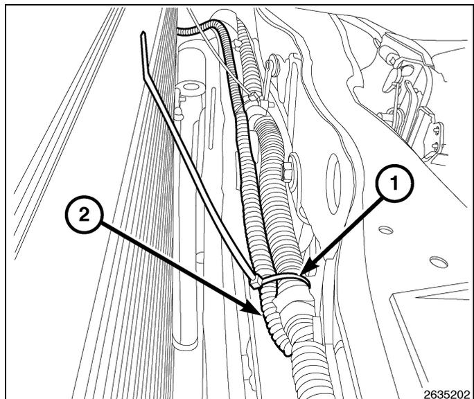
12. Coloque el mazo de cables del interruptor del capó (1) debajo del soporte de fijación del radiador hacia el interior de la aleta izquierda. Fije el mazo de cables del conmutador del capó (2) según sea necesario al mazo de cables existente del vehículo usando las bridas (1) incluidas en el kit.
