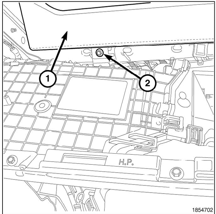
16. Acople las bisagras (1) de la guantera (2) en el panel de instrumentos.
