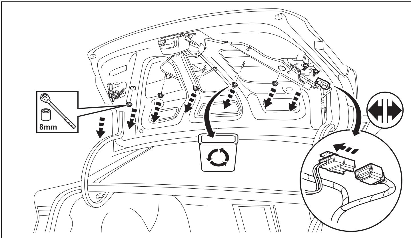
8. Appuyez sur les deux languettes de dégagement derrière les unités de montage d'ampoules des deux côtés du couvercle du coffre. Déposez délicatement l'applique de feux arrière du couvercle du coffre.
