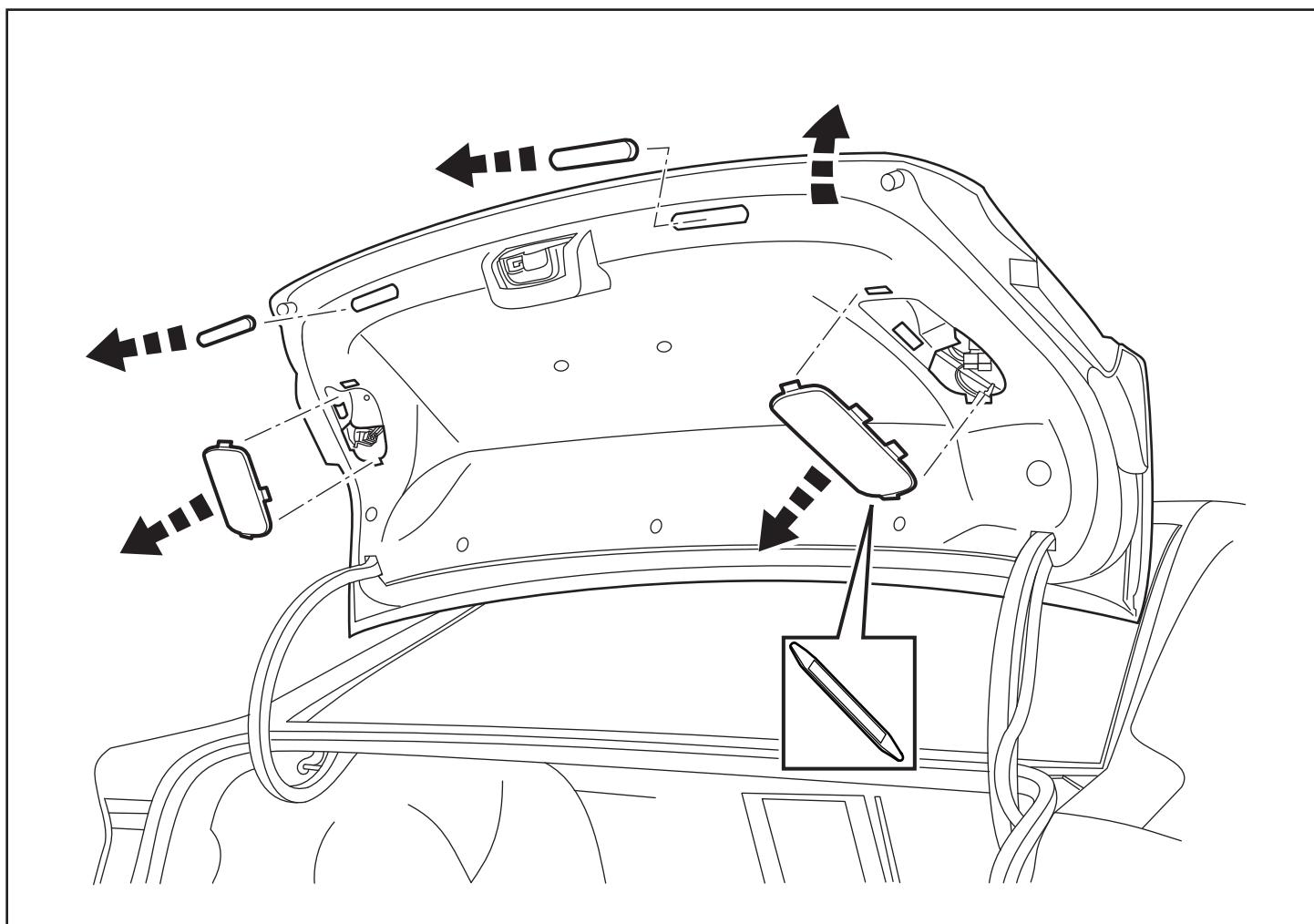
5. Utilisez un outil levier pour déposer les neuf (9) attaches à pression de la moquette garniture du coffre.
