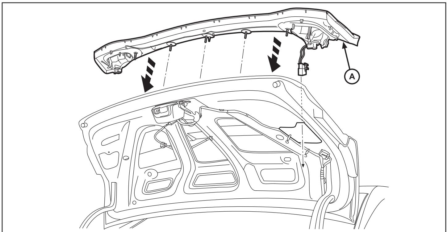
10. Reposez les cinq (5) écrous de 8 mm et resserrez les quatre (4) autres sous le couvercle du coffre. Rebranchez le connecteur à six (6) broches au côté droit du couvercle du coffre.
