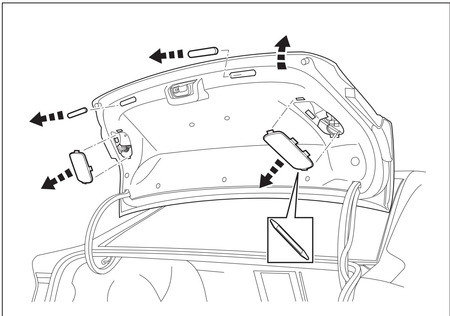
5. Use una herramienta de palanca para quitar nueve (9) broches de presión del panel de revestimiento del maletero.
