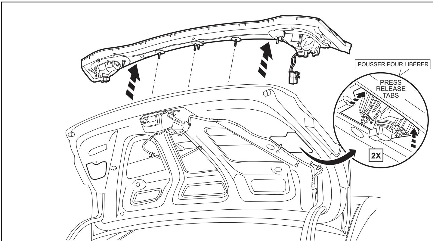
9. Installez délicatement la nouvelle applique de feux arrière sur le couvercle du coffre. Assurez-vous de passer le faisceau de câbles/connecteur à six broches dans l'ouverture sur la droite.
