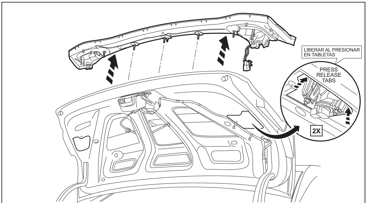
9. Instale el Nuevo ornamento de la luz trasera en la tapa del maletero. Asegúrese de encauzar el enchufe del conector de 6 vías correctamente en el hueco del lado derecho.
