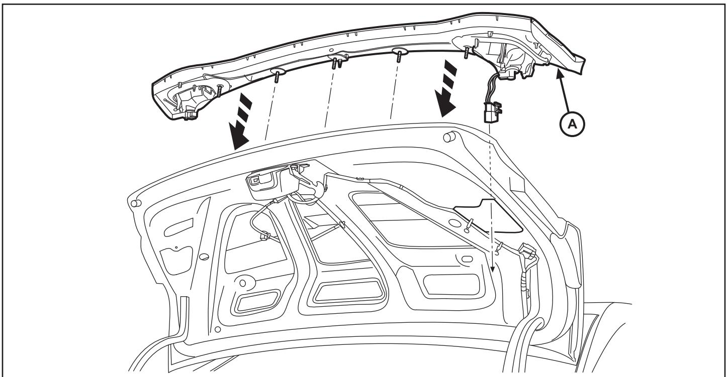
10. Reinstale cinco (5) tuercas de 8mm y vuelva a apretar las cuatro (4) tuercas de 8mm dentro de la tapa del maletero. Vuelva conectar el enchufe de 6 vías en el lado derecho de la tapa del maletero.
