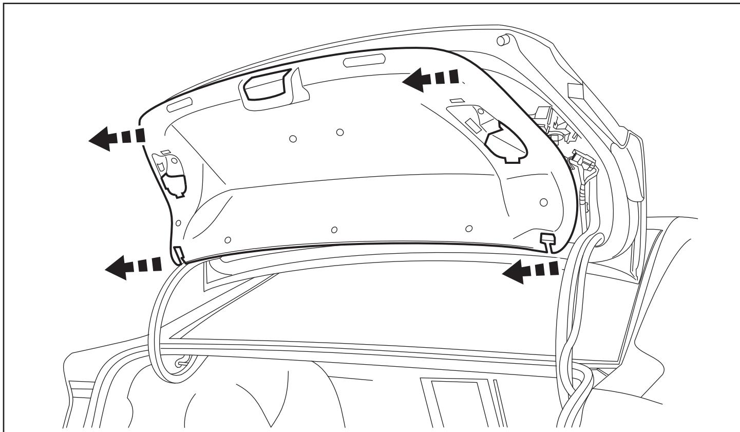
7. Quite las cinco (5) tuercas de 8mm del centro de la tapa del maletero. Afloje las cuatro tuercas restantes de 8mm en los lados derecho e izquierdo de la tapa sin quitarlas por completo. Desconecte el enchufe de 6 vías del lado derecho de la tapa del maletero.
