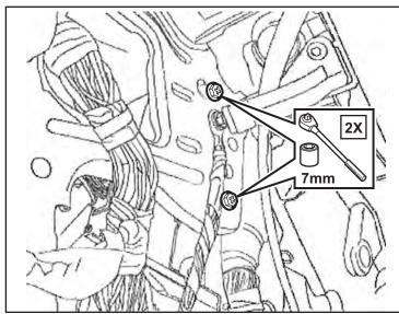
Desserrez l'une (1) vis 7 mm support de montage amplificateur situé dans la partie supérieure. Retirer l'amplificateur et le support.
