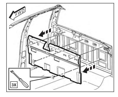
40. Localisez le module existant à l'arrière mur. Débranchez tous les connecteurs de faisceau. Retirer les deux (2) repousser la visserie broches. Retirez le RF Module Hub.
