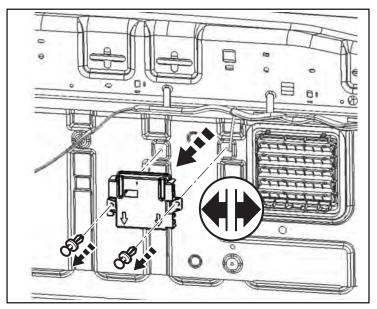
41. Coloque el nuevo módulo de RF Hub (C) en la posición. Asegure el módulo de RF Hub en la pared con dos (2) presionar pasadores previstos (F) y vuelva a conectar todos los conectores del arnés.
