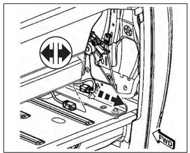
25. Eliminar un (1) perno de fijación de la correa de centro para el retractor. Coloque el cinturón a un lado.
