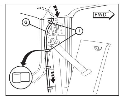
46. Conecte el cable de puente (G) en el módulo de RF Hub (C) detrás del asiento trasero.
