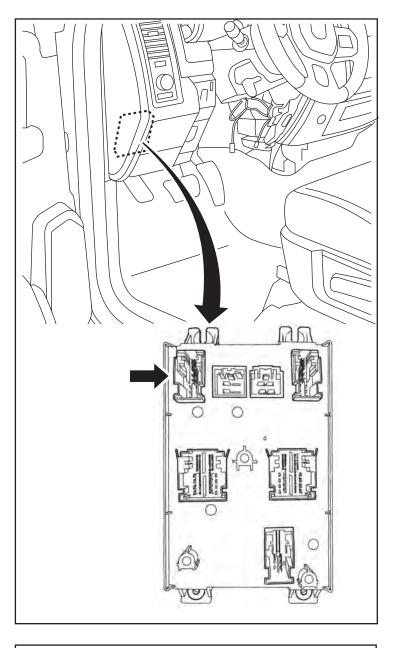
13. Presione las lengüetas de liberación en la parte posterior del conector y deslice el enchufe de la carcasa exterior.
