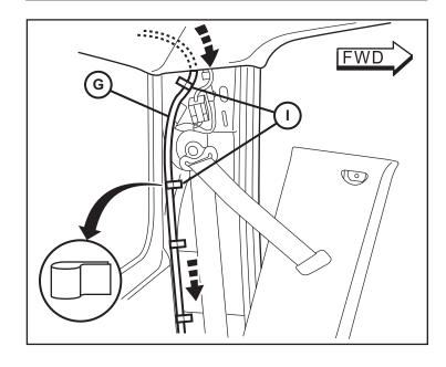
46. Branchez le câble de raccordement (G) dans le RF Hub module (C) derrière le siège arrière. Fixez le câble le long de l'arrière mur tous les 150mm avec bande Strap (I).
