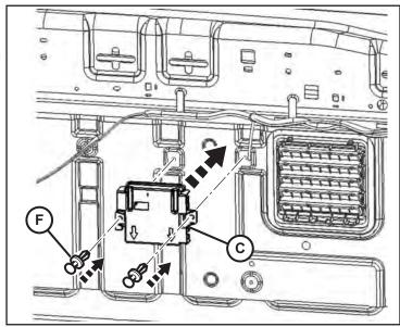
42. Quite los tornillos y los dos (2) ganchos de el borde posterior del panel de revestimiento superior. Con cuidado, levante el panel hacia abajo lo suficiente para localizar los orificios de montaje de antena por encima de la luneta trasera.
