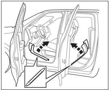
33. Liberar a todos los clips de sujeción y retire el panel de guarnición inferior.
