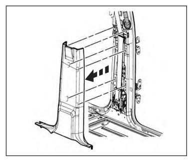
34. Utilice una herramienta de eliminación del ajuste para desmontar las cubiertas de los tornillos en la manija. Quite los dos (2) tornillos del mango y retire la manija de la B-pilar. Retire la correa de asiento girando bucle y retire el perno de lazo de inflexión. Utilice una herramienta de eliminación del ajuste a liberar a todos los clips de sujeción y retire el panel de ajuste de la B-pilar. Eliminar el cinturón de seguridad desde el panel de ajuste y retire el panel del vehículo.
