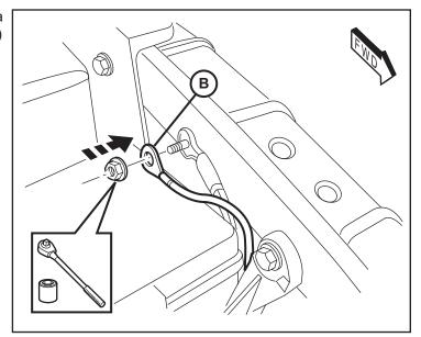
10. Localiser le joint en caoutchouc à l'arrière du moteur compartiment. Couper l'extrémité du tube d'accès et acheminer l'extrémité de faisceau de câbles (B) par l'intermédiaire de l'intérieur. Appliquer du RTV mastic pour le câblage électrique et tirez sur le faisceau de câbles dans le tube à sceller.
