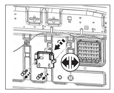
41. Placez le nouveau RF Hub module (C) en position. Fixez le module au mur avec deux (2) attaches fournies (F) et rebranchez tous les connecteurs de faisceau.
