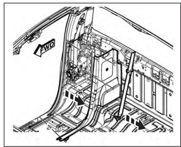
31. Utilice una herramienta de eliminación del ajuste para eliminar el cinturón de seguridad girando bucle cubrir. Quite el perno de lazo de inflexión. Retire el panel de ajuste superior e libere a todos los clips de sujeción.
