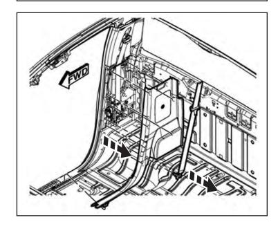
31. Utilisez un bâton de garniture pour enlever la ceinture de sécurité tournant en boucle couvrir. Retirez le boulon de tourner en boucle. Retirez le supérieure panneau de garnissage et de libérer les clips de retenue.
