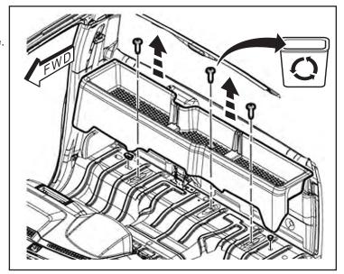
NOTE: Les panneaux d'habillage intérieur suivantes doivent être enlevés pour permettre la garniture de toit soit abaissé. c'est nécessaires pour monter correctement le module d'antenne.
