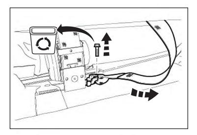
26. Retirer les boulons arrière extérieures, arrière boulons intérieurs et ceintures de sécurité si nécessaire.
