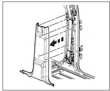
34. Utiliser un bâton garniture d'enlever les couvercles à la poignée. Enlever les deux (2) attaches de la poignée et retirer la poignée de la B-pilier. Retirez le couvercle de la ceinture de sécurité et enlever le boulon de tourner en boucle. Utilisez un bâton de garniture de libérer tous les clips de fixation et retirer le panneau à partir du montant central. Retirer la ceinture de sécurité à partir du panneau et retirez le panneau du véhicule.
