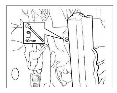
12. Localisez le BCM derrière le côté gauche du tableau de bord. Localiser et retirer le connecteur en haut à gauche de la BCM comme indiqué.
