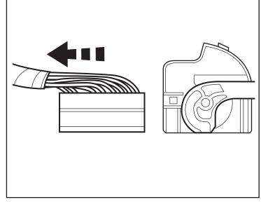
14. Coloque el Pin 11 del conector.
