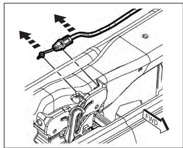
Rebranchez le câble de déverrouillage à l'arrière de loquet du capot nouvelle. Placez la nouvelle loquet (A) avec les marques de crayon et fixez-le avec deux boulons hexagonaux (2). Serrer les boulons à 11 Nm (8 lb-pi.)
