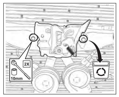
4. Débranchez et retirez le câble de déclenchement. Retirer le loquet du capot.
