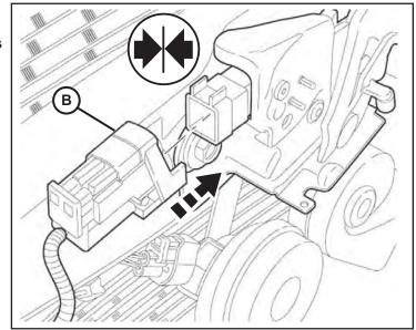
7. Acheminer le faisceau (B) sous le radiateur supérieure barre de métal et plus vers le côté conducteur le long d' le harnais de véhicule existant. Fixer avec des attaches de câble (E).
