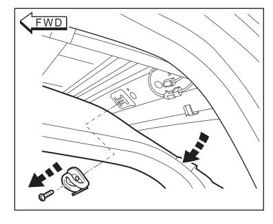
43. Placez le module d'antenne (D) ci-dessus à l'arrière fenêtre. Fixer en place en appuyant deux (2) attaches (J) dans les trous de fixation prévus.
