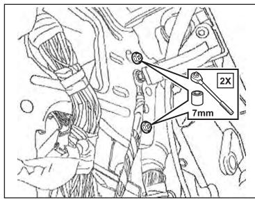
14. Afloje el (1) tornillo de montaje de amplificador de 7 mm en la parte superior. Eliminar el amplificador y el conjunto de soporte.
