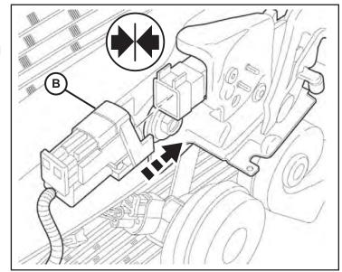
7. Pase el cableado del interruptor (B), bajo la superior del radiadorla barra transversal ya lo largo de más hacia el lado del conductor el arnés del vehículo existente. Asegure con lazos (E).
