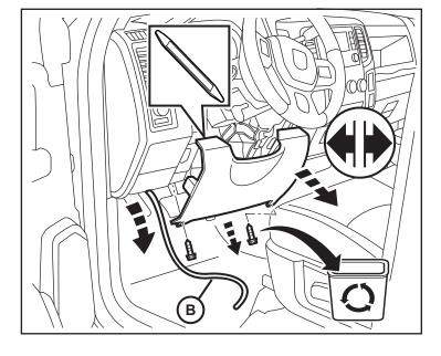
REMARQUE: Il peut être équipé d'un amplificateur audio monté à l'avant de la BCM. L'amplificateur doit être retirée pour permettre l'accès au BCM.
