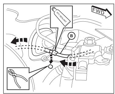
11. Retirez les deux attaches au bas du panneau de garnissage au-dessous du volant de direction. Retirez le loquet du capot. Débrancher le connecteur de liaison de données et enlever le panneau de garnissage. Tirez le harnais (B) jusqu'à l'intérieur.
