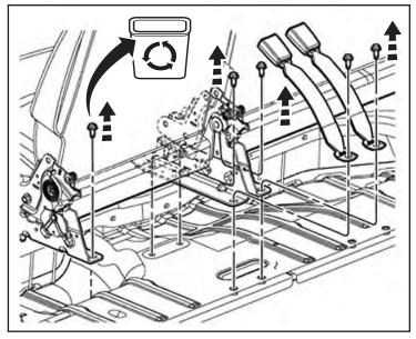
27. Enlever les éléments de fixation à l'avant du siège. Lever les ensembles de sièges et séparer trois (3) cabine à l'arrière des crochets. Retirez le siège du véhicule.
