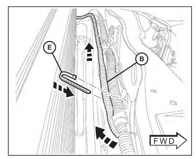
Pasar el mazo (B) debajo del lado conductor radiador soporte. Coloque con cuidado la parte posterior mazo de cables hacia la parte trasera del compartimiento del motor por pasándolo por detrás y debajo de la caja de fusibles y el batería.
