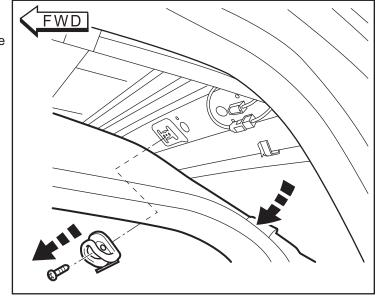
43. Coloque el módulo de antena (D) por encima de la parte trasera ventana. Asegura en su lugar presionando dos (2) Árbol de navidad del sujetador (J) en los orificios de montaje.
