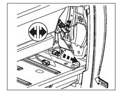
25. Retirer un (1) boulon de fixation ceinture d'épaule centre de l'enrouleur. Déplacez le baudrier sur.
