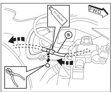
11. Retire los dos tornillos en la parte inferior del panel de ajuste bajo el volante. Con cuidado, saque el pestillo de liberación del capó. Desconecte el conector de datos enchufe y quitar el panel de ajuste. Tire del arnés (B) hasta el interior.
