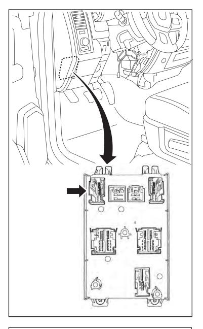
13. Appuyez sur les languettes de dégagement de la coquille du connecteur à (à l'arrière du connecteur) et séparez le connecteur de la coquille.
