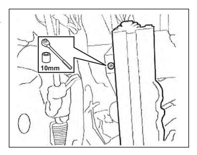
12. El BCM se encuentra detrás del tablero de instrumentos, en el lado izquierdo. Localice y retire el conector de la parte superior izquierda de la BCM como se indica.
