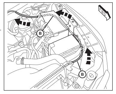
Le long du bord extérieur à côté de la batterie, retirez la existant écrou fil de terre. Placer la cosse de masse (B) du faisceau de câbles principal en position et refixer l'écrou.
