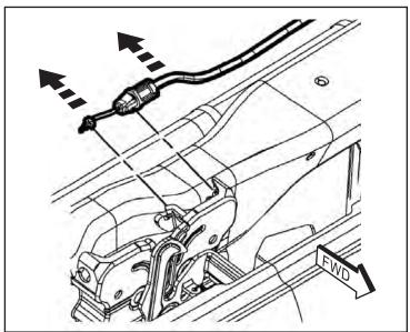
5. Vuelva a conectar el cable de liberación de pestillo de la cubierta de la parte posterior del pestillo de la cubierta nueva. Coloque el pestillo de la cubierta nueva (A) con las marcas de lá'e1piz y asegure con dos (2) pernos hexagonales. Apriete los tornillos a 11 Nm (8 lb-pie).
