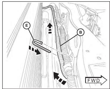
8. Acheminer le faisceau (B) sous le côté conducteur support de montage du radiateur. Faites passer soigneusement le dos harnais vers l'arrière du compartiment moteur par il passe derrière et sous la boîte à fusibles et le batterie. Les attache-câbles ne devraient pas être distancés de plus de 100 mm (E).
